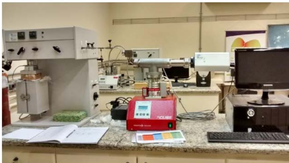
Figura 3.7. Equipamento para o ensaio de Espectroscopia de Dessorção Térmica (TDS).
