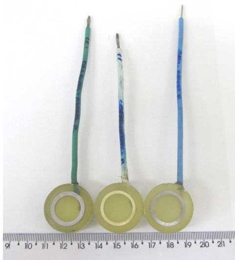
Figura 18 - Eletrodos fabricados a partir de tubos de permutador de calor para realização de ensaios eletroquímicos em bancada.
