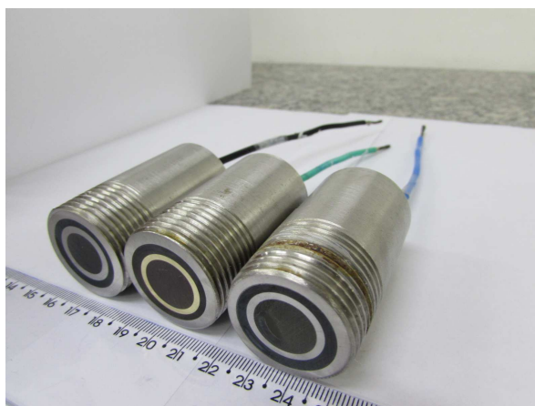
Figura 19 - Eletrodos fabricados a partir de tubos de permutador de calor para realização de ensaios eletroquímicos no loop de corrosão.
