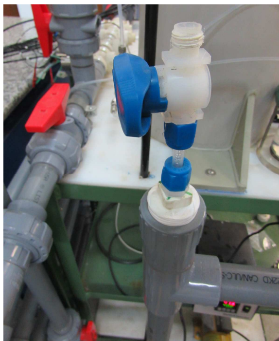
Figura 27 – Dispositivo para injeção de diesel
