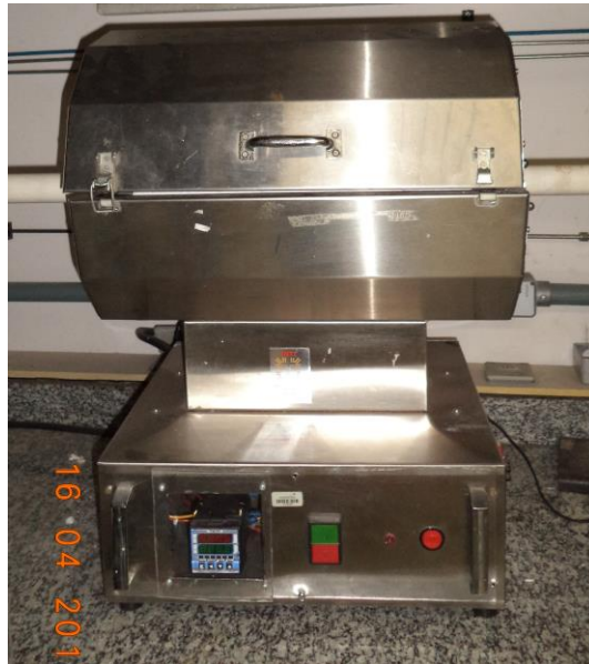
Figura 18: Fotografia do Forno tubular utilizado no tratamento térmico.
