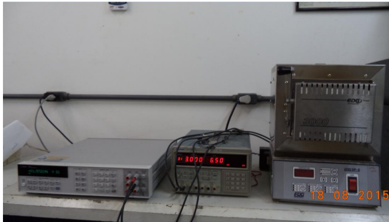
Figura 22: Fotografia do aparato de medida elétrica utilizado para determinação da REA.
