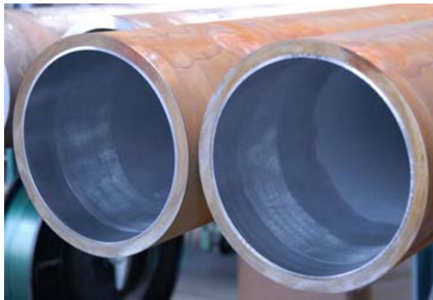
Figura 1 - Tubos cladeados internamente por processo de soldagem [9].
