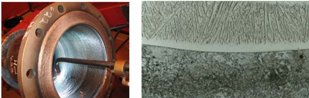
Figura 7 - Fabricação de camadas cladeadas usando processo de soldagem TIG [39].
