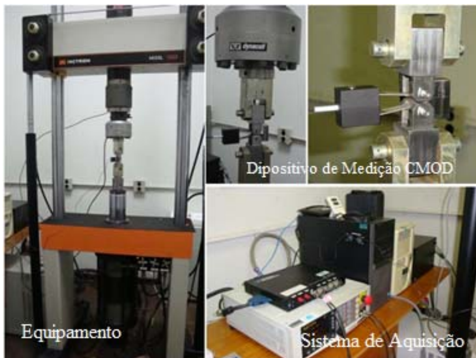
Figura 41 – Montagem do sistema de ensaio de CTOD do laboratório de mecânica da fratura do PEMM.
