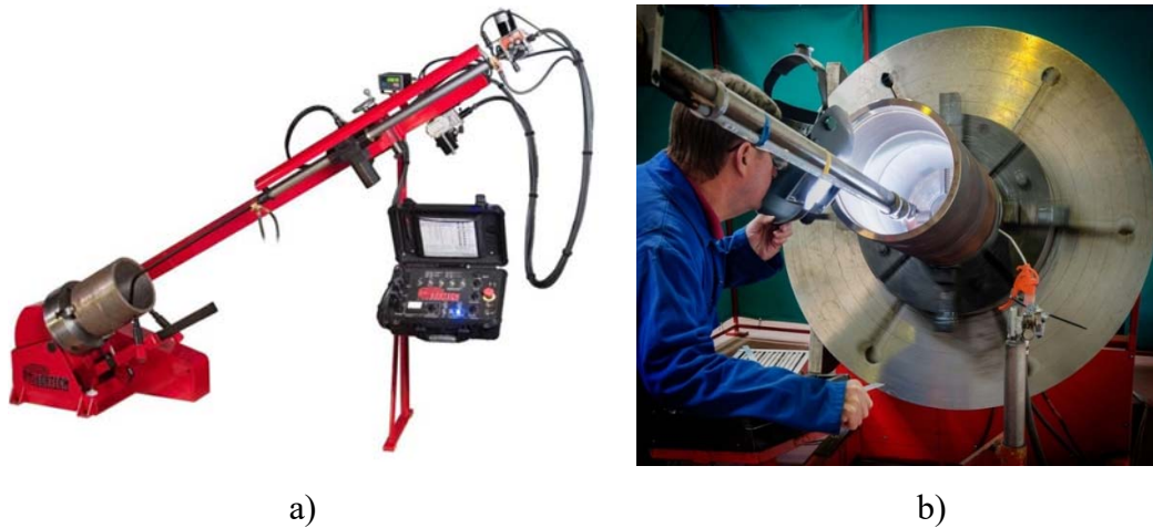
Figura 6 - Máquina de soldagem automatizada TIG para a produção de sobre camada interna de tubos. a) Equipamento completo [39, 40].
