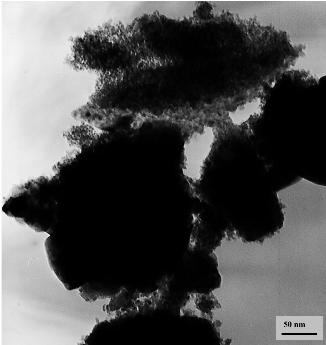
Figura 40 - Fotomicrografia de microscopia eletrônica de transmissão do pó da ferrita \text{Ba}_3\text{Co}_{1,2}\text{Zn}_{0,4}\text{Cu}_{0,4}\text{Fe}_{24}\text{O}_{41} , após calcinação a 950^\circ\text{C} . Ampliação de 100.000 vezes, operando a 200 KV.
