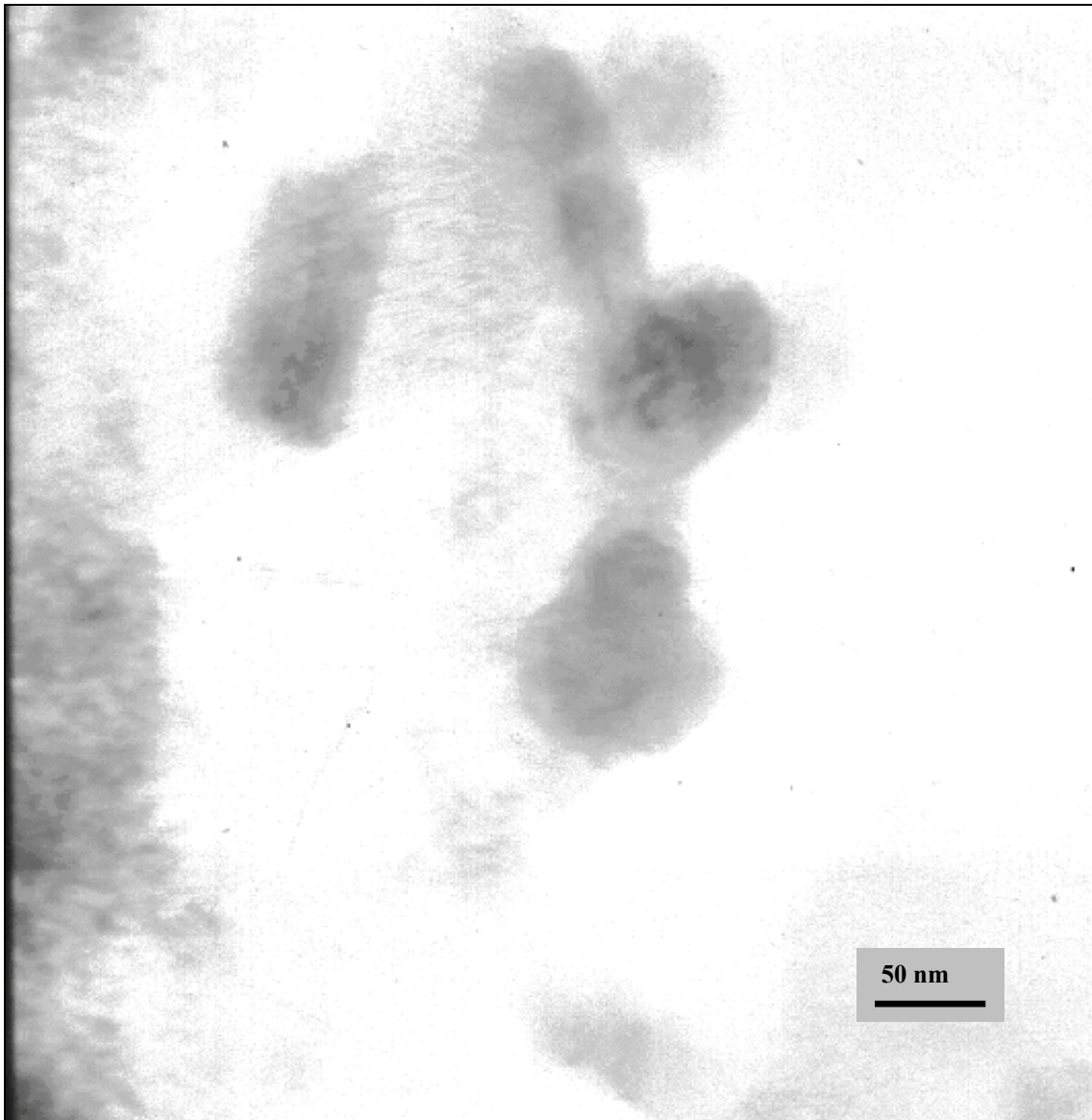
Figura 41 - Fotomicrografia eletrônica de transmissão do pó da ferrita \text{Ba}_3\text{Co}_{0,6}\text{Zn}_{0,4}\text{CuFe}_{24}\text{O}_{41} , após calcinação a 950^\circ\text{C} . Ampliação de 100000 vezes, operando a 200 kV.
