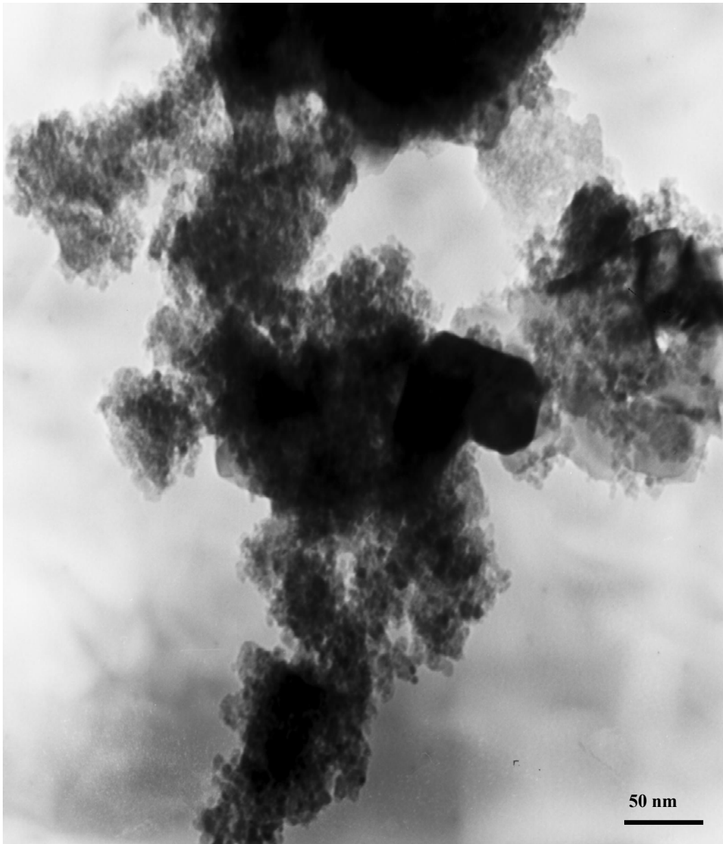
Figura 38 - Fotomicrografia eletrônica de transmissão do pó da ferrita \text{Ba}_3\text{Co}_{1,6}\text{Zn}_{0,4}\text{Fe}_{24}\text{O}_{41} , após calcinação a 950^\circ\text{C} . Ampliação de 100000 vezes, operando a 200 kV.
