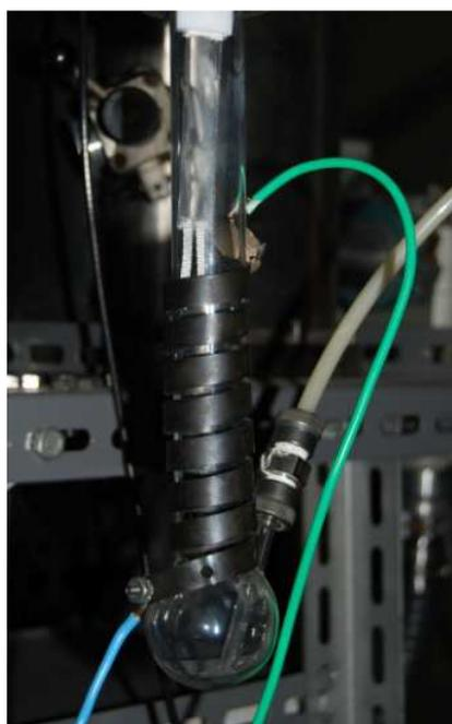
FIGURA 5 – Câmara tubular com duas amostras de fibras para aplicação de plasma.
