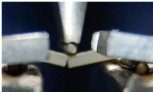
FIGURA 23 - Corpo de prova do material *Signum* durante ensaio de flexão.
