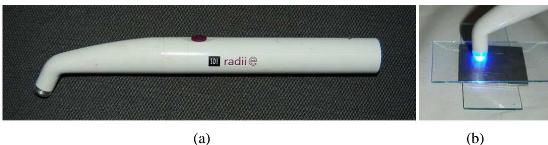
FIGURA 7 – a) fotoativador *Radii E* da *SDI* e b) fotoativação manual do corpo de prova.
