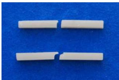
FIGURA 31 - Corpos de prova do material *Signum* após os ensaios de flexão.
