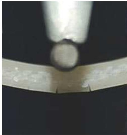
FIGURA 38 - Corpos de prova com fibras afastadas da base durante ensaios de flexão mostrando trincas formadas na base próximas ao centro da amostra.
