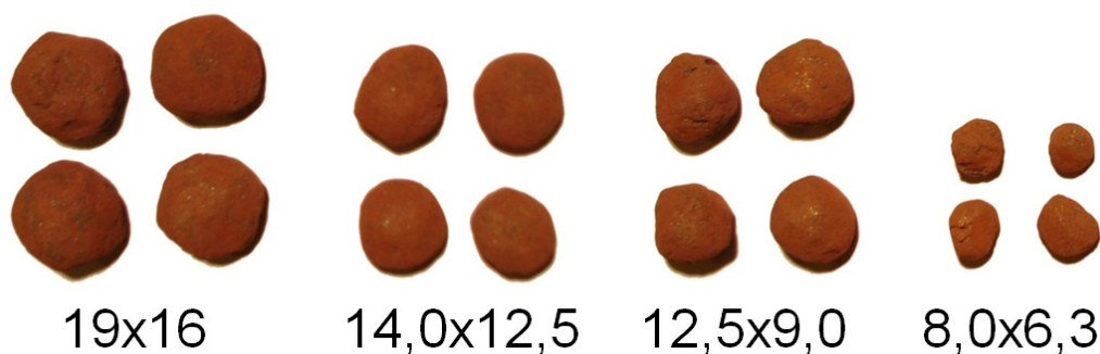
Figura 4.1 Pelotas de Minério de ferro nas diferentes faixas de tamanho de partícula
