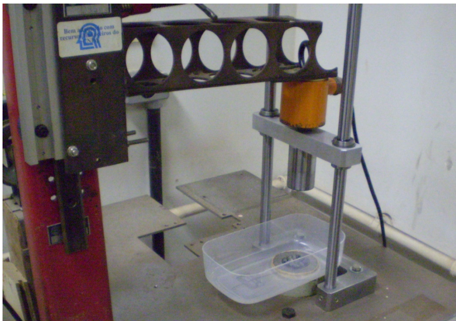
Figura 4.9 Sistema de queda de peso para ensaio de fragmentação de partículas individuais do LTM
