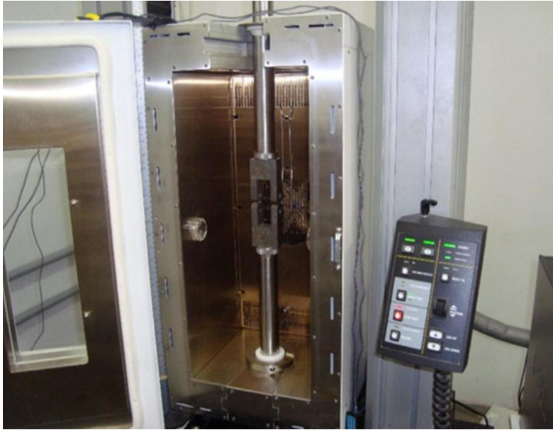
Figura 24 – Detalhe dos dispositivos para testes de fratura a -50\text{ }^{\circ}\text{C}
