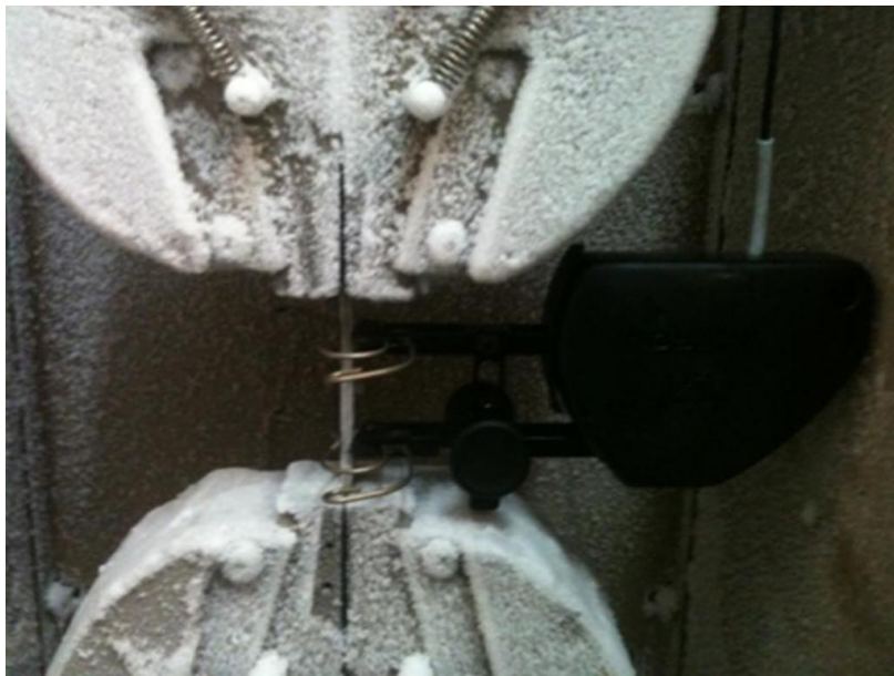
Figura 22 - Corpo de prova de tração com extensômetro durante testes a -50^{\circ}\text{C}
