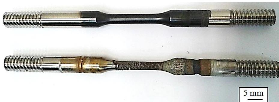
Figura 4.5.56 – Macrografia dos corpos de prova após os ensaios de corrosão sob tensão, mostrando acima o material na condição envelhecida (com as fases  $\gamma'$ ,  $\gamma''$  e  $\delta$ ) e abaixo na condição “como recebida” (sem as fases  $\gamma'$ ,  $\gamma''$  e  $\delta$ ).
