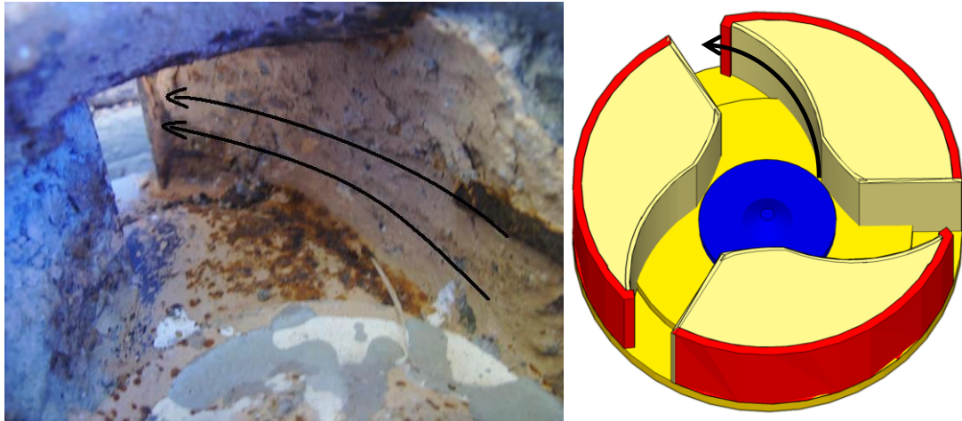
Figura VI-19 – Na foto, as linhas sobre o leito interno do rotor mostram o caminho das partículas para saída. No desenho esquemático é representada a imagem sendo indicado o mesmo caminho
