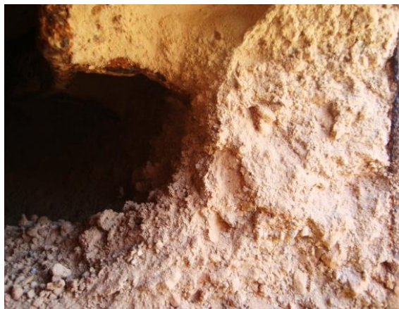
Figura VI-20 Volume ocupado pelas partículas na lateral inferior do britador (morto)
