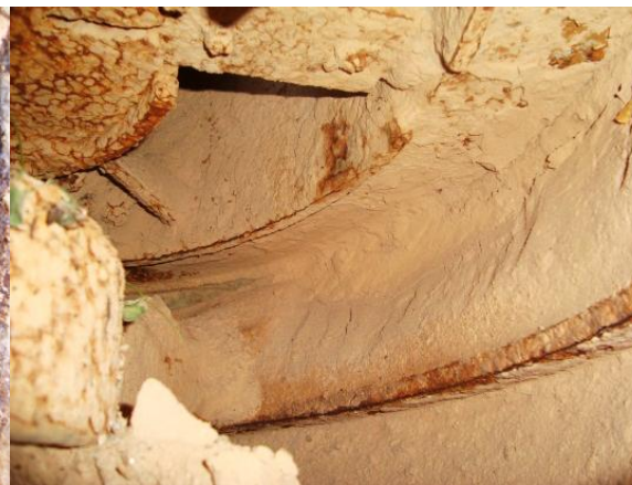
Figura VI-21 Volume ocupado pelas partículas na parte superior lateral do britador
