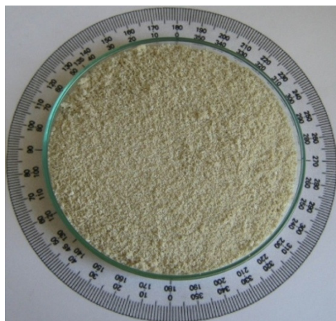
Figura 4.13 Macrofotografia da massa fundida obtida depois da fusão da mistura \text{NaOH}/\text{ZrSiO}_4 a 575\text{ }^\circ\text{C} por 30 min. Razão mássica \text{NaOH}/\text{ZrSiO}_4 de 15/10.
