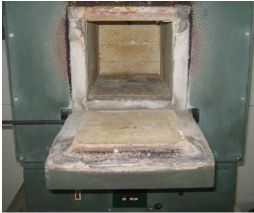
Figura 4.12 Forno mufla e panela de ferro utilizados no processo de fusão alcalina para produção de massa fundida.
