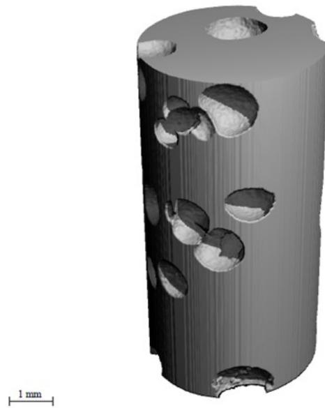
Figura 4.20: Reconstrução tridimensional obtida por microtomografia de raios X do material cerâmico poroso obtido pela pirólise do material polimérico curado sob 800 kPa
