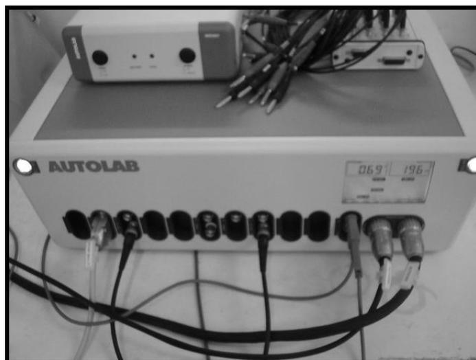
**Figura 41 - Potenciostato utilizado nos ensaios de polarização.**
