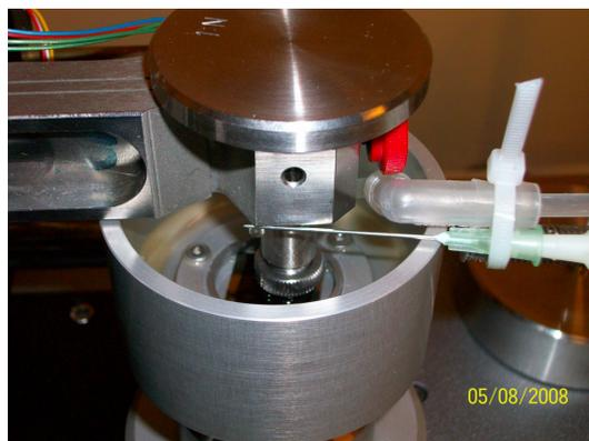
Figura 3.4 – Esquema da montagem experimental dos ensaios de tribologia com lubrificante. A seringa (gotejador) mantém a amostra úmida durante o experimento.
