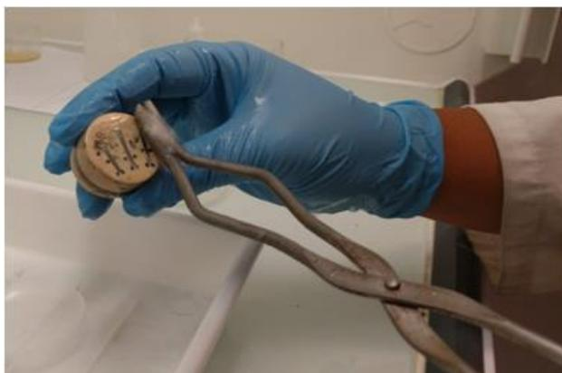
Figura 52: Ataque químico das amostras com solução Behara.
