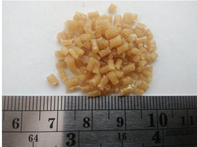
**Figura 14: Biocompósito PHBV/CM15/BS extrudado e peletizado.**
