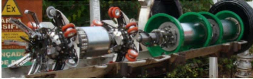
Figura 2.13: PIG geométrico [16].
