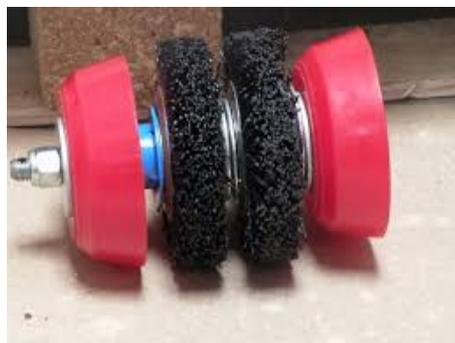
Figura 2.9: PIG raspador [10].
