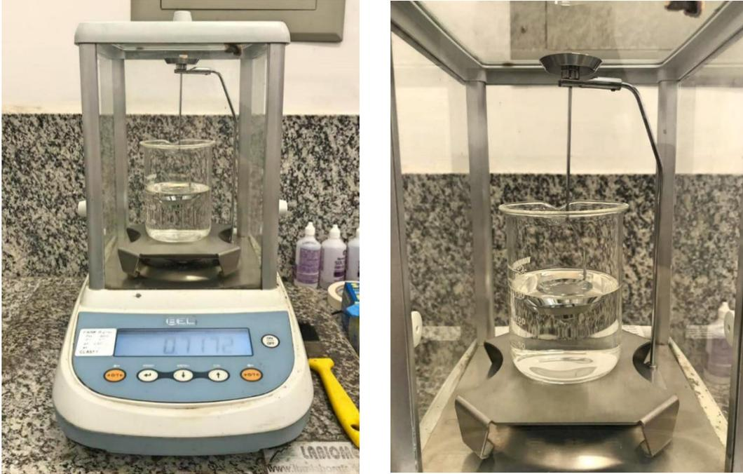
*Figura 10: Balança hidrostática (esquerda) e aparato específico para medição de densidade (direita).*
