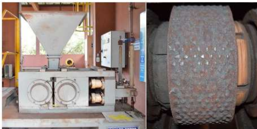
Figura 25. Prensa de rolos POLYCOM® utilizada nos testes de prensagem (BARRIOS, 2015)
