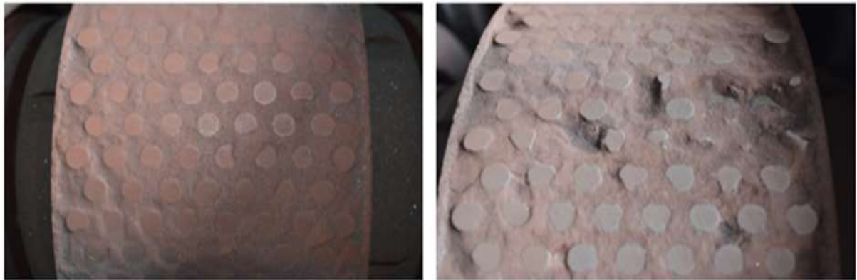
Figura 10. Rolo em boas condições e desgastado em uma prensa de rolos Polysius de laboratório
