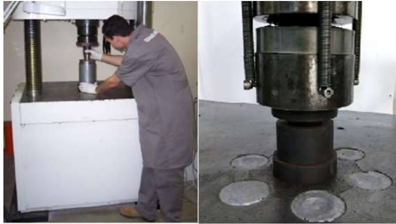
Figura 32. Prensa Shimadzu e acoplamento copo pistão utilizados nos testes de CLP
