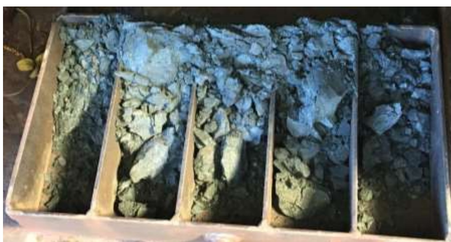
Figura 28. Caixa utilizada para coletar as amostras de produto de prensagem ao longo do eixo longitudinal do rolo
