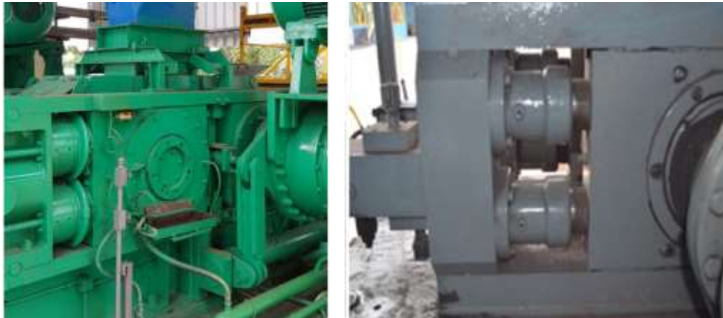
Figura 6. Sistema hidráulico e acumuladores de nitrogênio para prensas de rolos em escala piloto (esquerda) e prensa de laboratório (direita)
