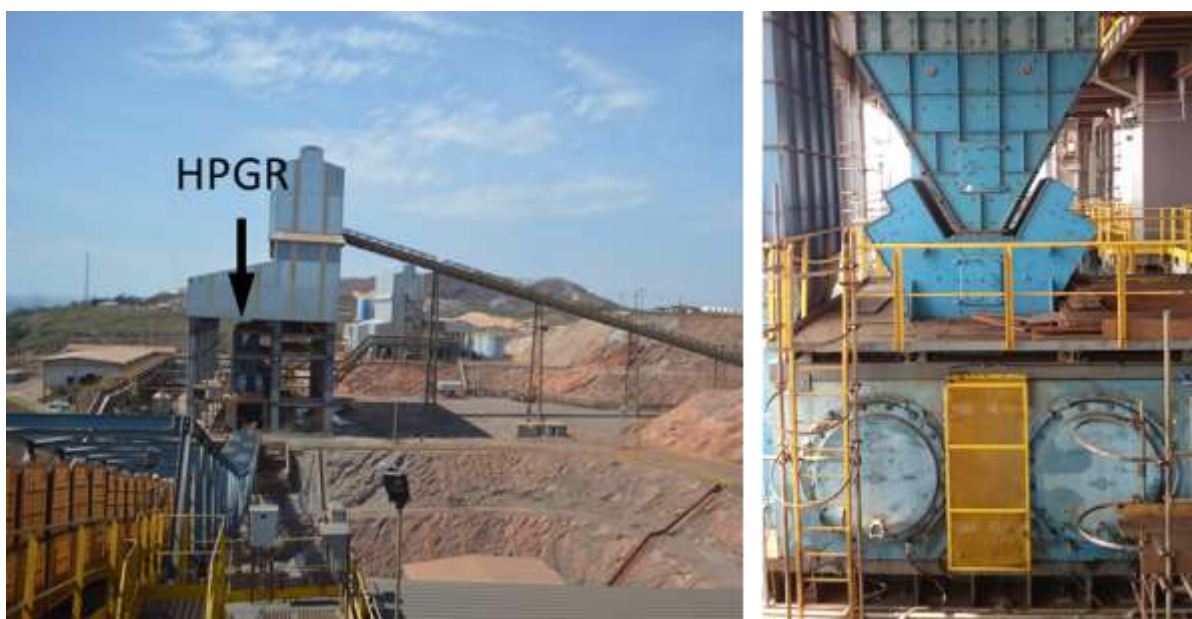
Figura 26. Prensa de Rolos industrial utilizada nos testes de prensagem
