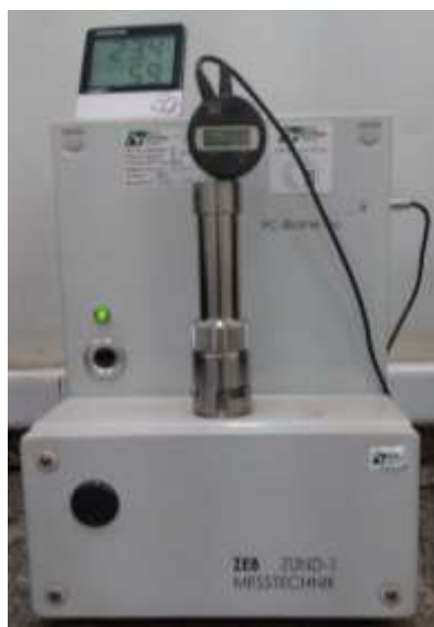
Figura 30. Blainímetro utilizado na medição de área superficial específica das amostras de pellet feed
