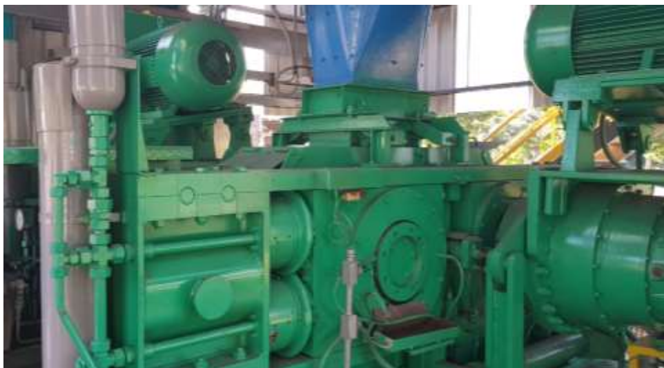
Figura 27. Prensa de rolos em escala piloto utilizada nos testes
