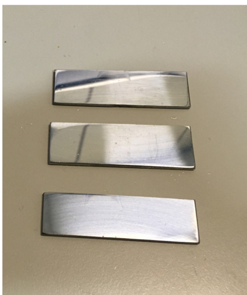
Figura 22: Corpos de prova após corte, lixamento e limpeza no ultra-som. Fonte: Acervo Pessoal.
