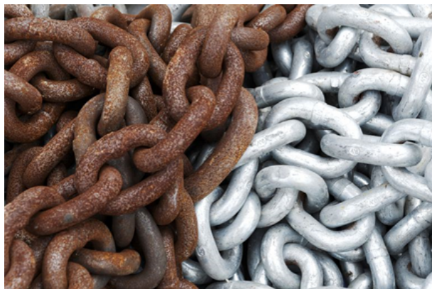
Figura 2.1: Comparação entre uma superfície que sofreu corrosão generalizada e outra sem indícios de corrosão [4].
