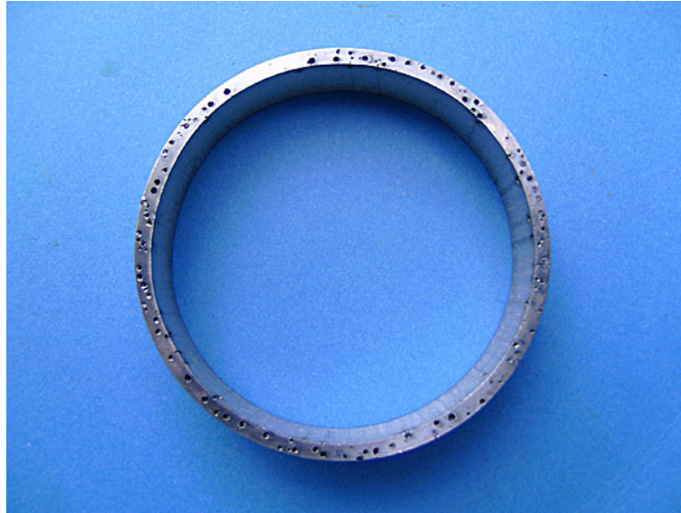
Figura 2.2: Corrosão por pites em amostra de aço inoxidável [7].
