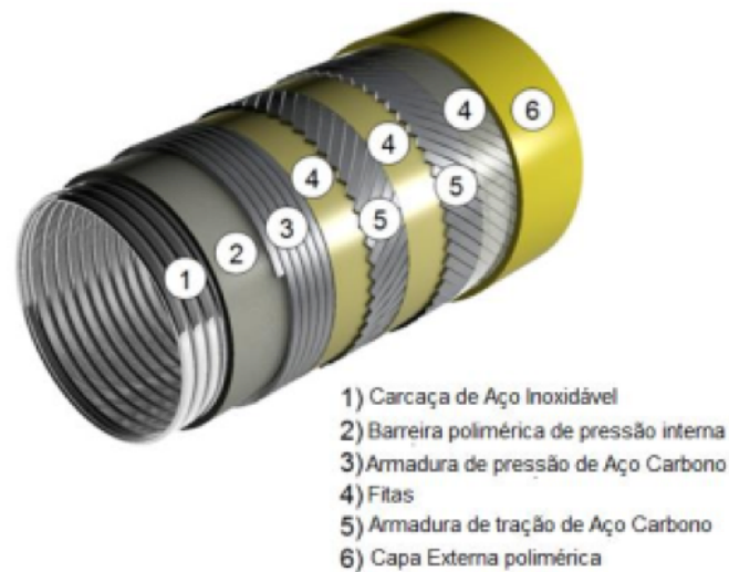
Figura 2.7: Camadas de um duto flexível (adaptada) [23].
