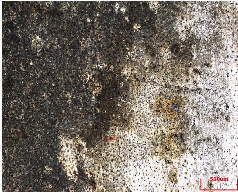
Figura 5.18: Região analisada onde foi verificado pite mais profundo para o ensaio de imersão durante 64 horas em solução de NaCl 19% com CO 2 , sem renovação do meio.
