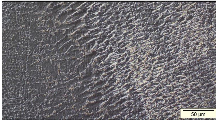
Figura 32 - Aspecto microestrutural do MS do tubo A com TTAT obtido por MO. Aumento de 1000x. Kalling's seguido de água régia.
