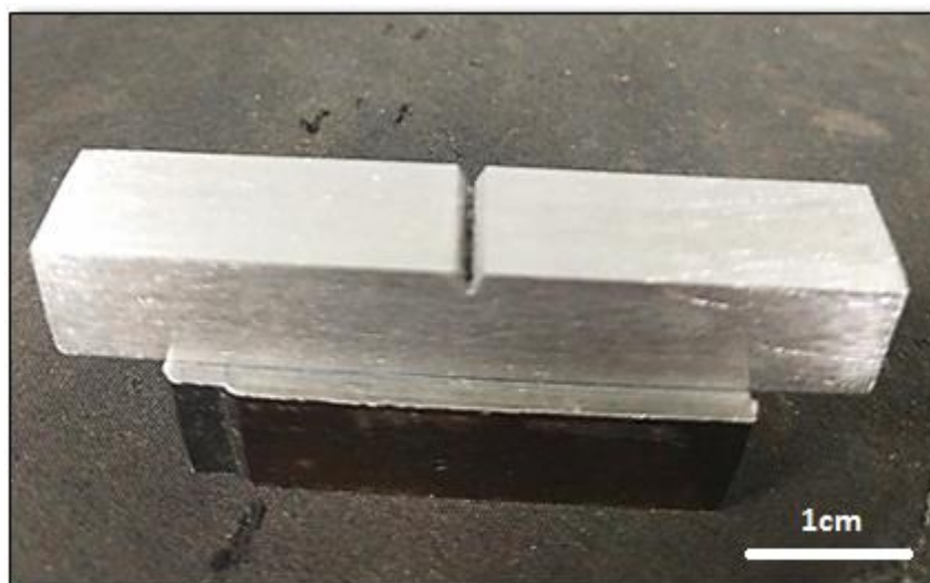
Figura 22 - Corpo de prova de Charpy sob a sessão do produto tubular ilustrando a orientação do entalhe
