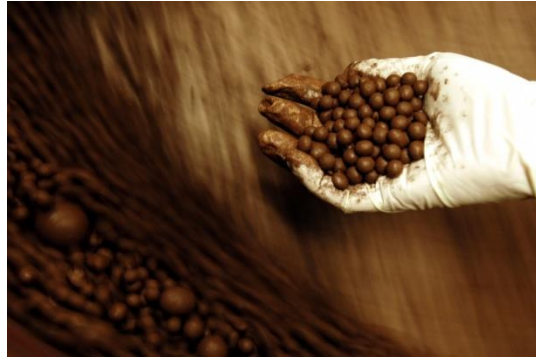
Figura 5 – Exemplo de processo de pelotização.
