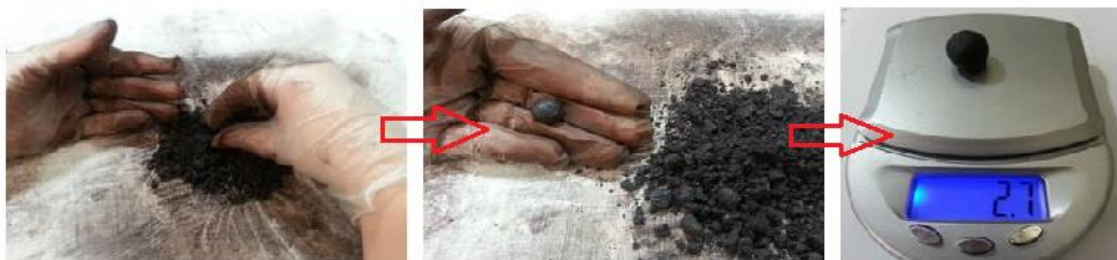
Figura 12 – Procedimento de produção das pelotas convencionais e auto-redutoras.
