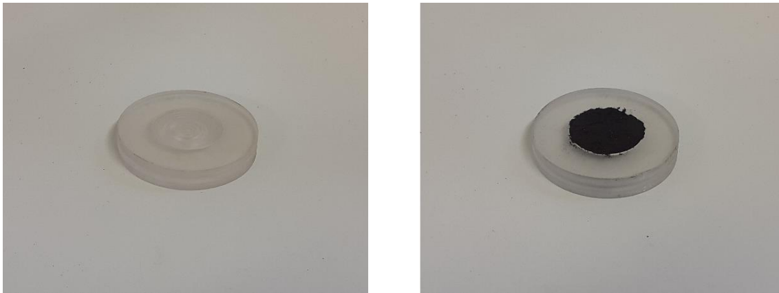
Figura 14 – Porta amostras (a) sem amostra e (b) com amostra posicionada.
