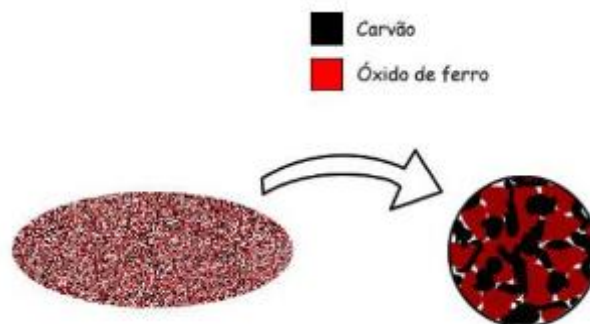
Figura 3 – Exemplo de aglomerado auto-redutor (Adaptado de [8]).
