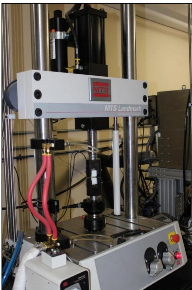
**Figura 47 - Servo-hidráulica MTS.**
