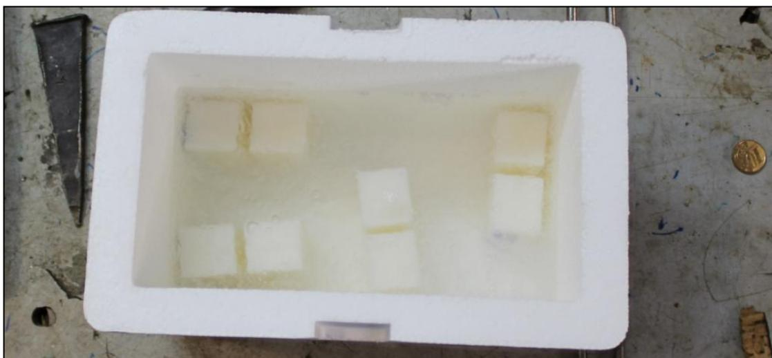
**Figura 59 - CPs imersos em Nitrogênio líquido.**
