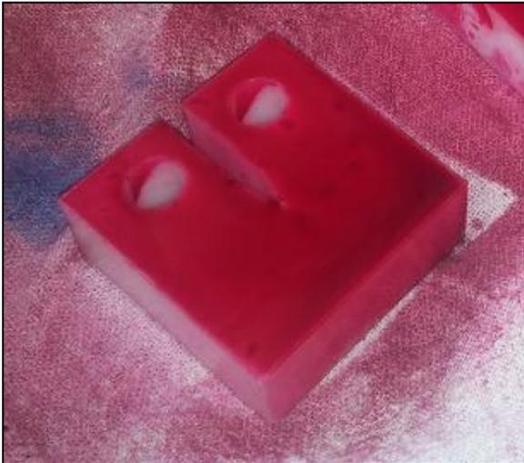
**Figura 48 - Ensaio de líquido penetrante.**
