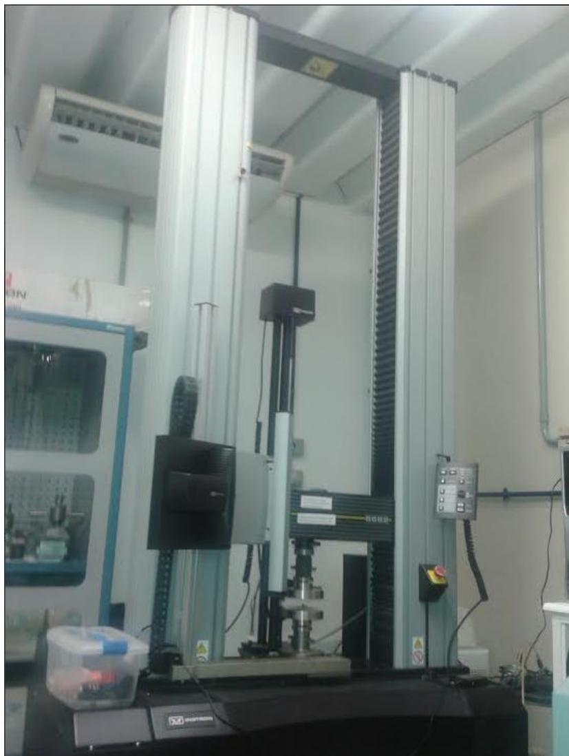
**Figura 45 - Máquina para ensaios de tração (modelo Instron - sistema eletromecânico).**
