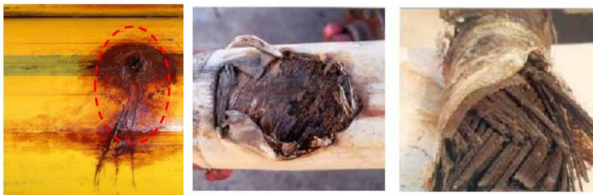
**Figura 3 - Corrosão em armadura de aço devido à presença de danos na imagem à esquerda [2] ou fissuras na camada polimérica externa na figura à direita [3] de uma linha flexível, ocasionando a falha em serviço.**
