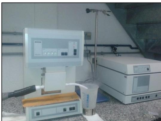
Figura 25 - Dispositivo experimental para ensaios DMA.
