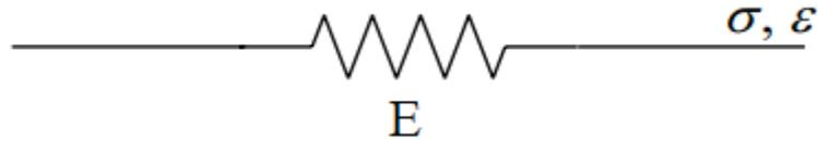
**Figura 14 - Mola representando material elástico (corpo de Hook) adaptado de [26].**
