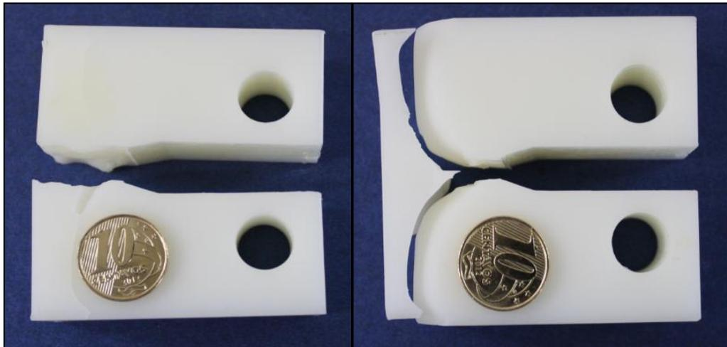
**Figura 62 - Ruptura de CPs com auxílio de uma cunha após imersão em nitrogênio líquido.**
