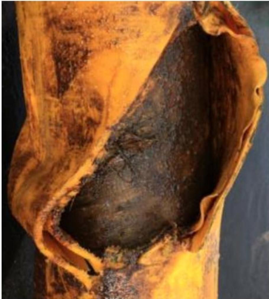
**Figura 4 - Explosão de camada externa de *riser* em função do aumento da pressão interna do anular devido à permeação de gás na estrutura [1].**
