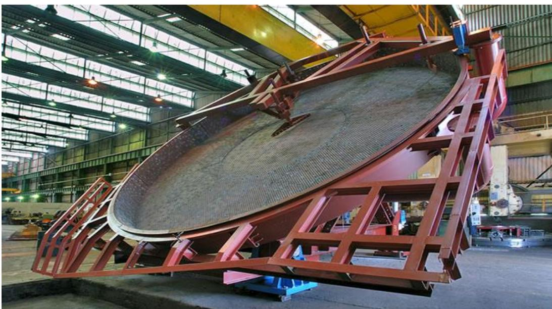
Figura 14- Tecnometal: Foto de Disco de Pelotamento
