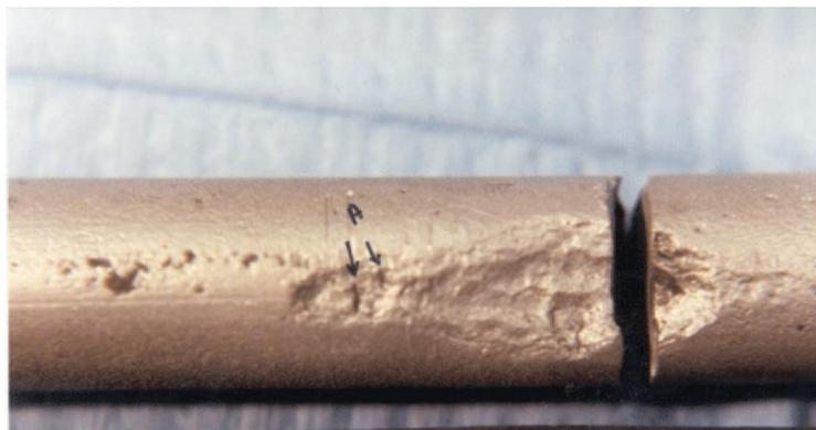
Figura 16 - Trincas induzidas por sulfeto podem ocorrer quando a corrosão por  $H_2S$  é aceleradas por tensões
