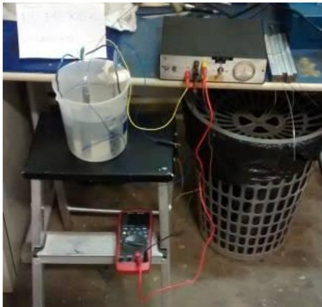
Figura 26 - Foto do sistema de hidrogenação por proteção catódica em solução aquosa 3,5% NaCl com sobretensão aplicada de -1,50V.
