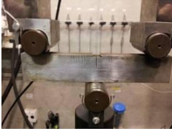
Figura 23 - Corpo de prova marcado e pronto para a pré-trinca
