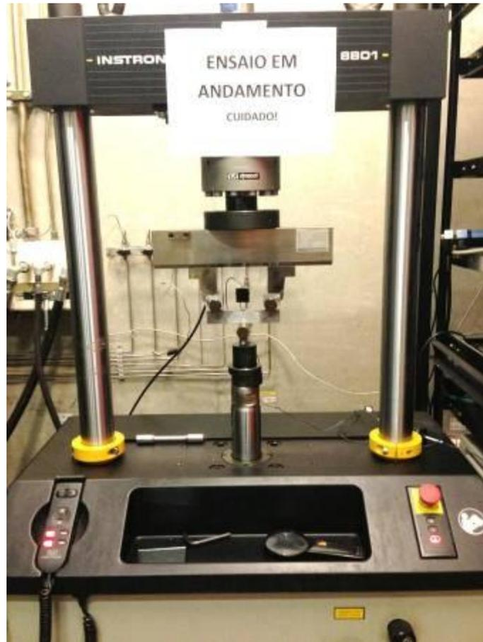
Figura 22 - Ensaio de tenacidade à fratura na servo hidráulica da marca Instron modelo 8801.
