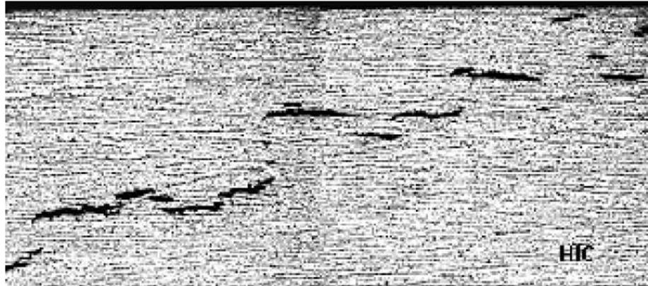
Figura 15 – Trinca induzida por hidrogênio em estrutura metálica
