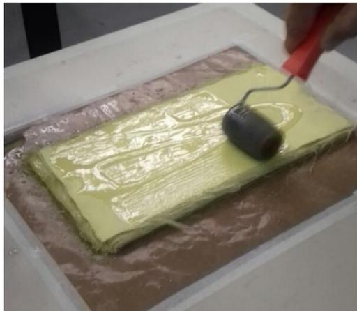
Figura 3.2 - Aplicação da resina sobre o tecido.
