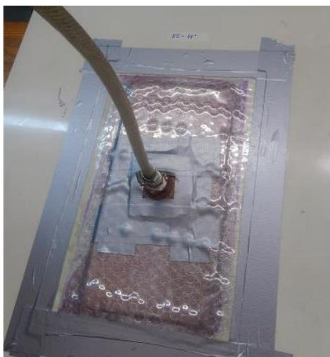
Figura 3.3 - Laminados preparados através da técnica de *vacuum bagging*.
