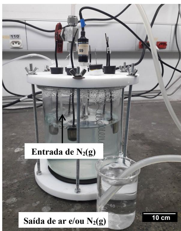
Figura 34. Configuração das células eletroquímicas utilizadas para a realização dos ensaios eletroquímicos na condição de desaeração
