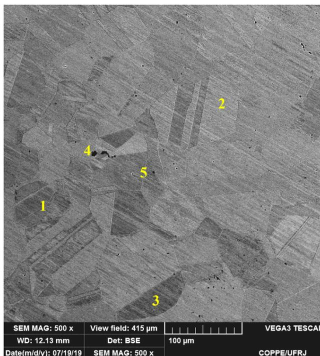
Figura 49. Micrografia da liga UNS S31603 obtida por MEV-EDS com aumento nominal de 500X - ataque eletrolítico com ácido oxálico conforme ASTM A262 – método A [109]
