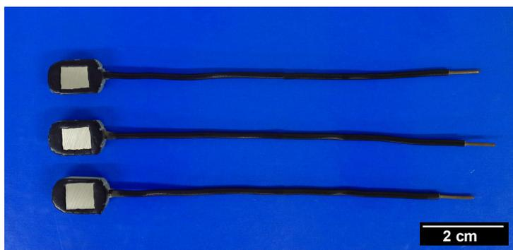
Figura 33. Configuração do corpo de prova dos ensaios eletroquímicos na condição estática
