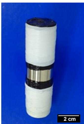
Figura 40. Corpo de prova utilizado como eletrodo de cilindro rotatório
