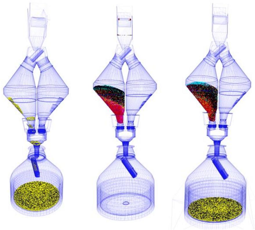
Figura 4.14 - Utilização da função Bed Block, descarga de coque simulada (esquerda), descarga de carga metálica a ser simulada sobre o leito de coque (centro) e junção do leito descarregado do coque com a descarga de minério a realizar (direita).
