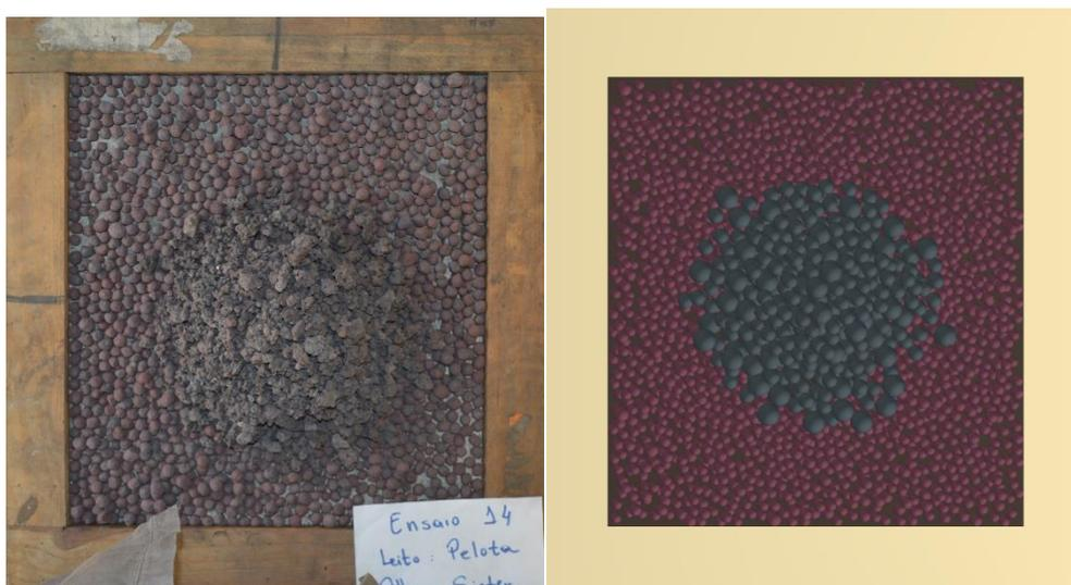
Figura 5.8 - Vista superior da pilha de sinter formada sobre leito de partículas de pelotas. Experimento (à esquerda) e simulação DEM (à direita).
