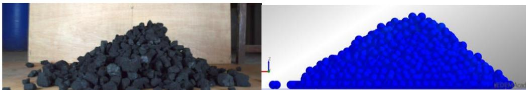
Figura 5.4 - Resultado de ensaio de ângulo de repouso (esquerda) com amostra de coque caracterizada previamente no Laboratório de Tecnologia Mineral comparada à sua respectiva simulação DEM (direita) (Lima, 2016).
