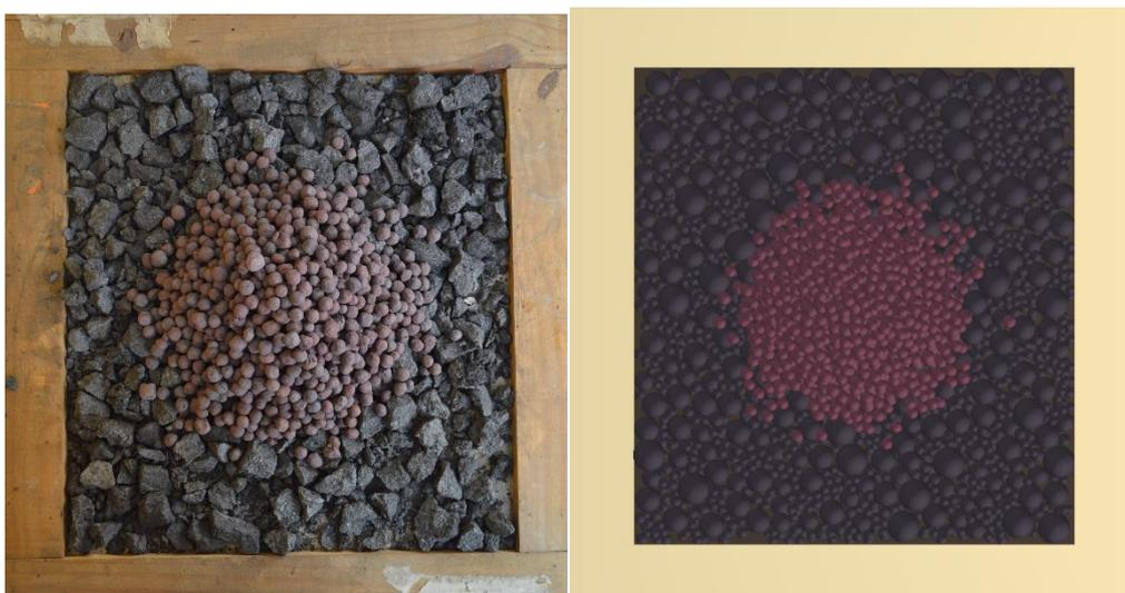
Figura 5.14 - Vista superior da pilha de pelotas formada sobre leito de partículas de coque
