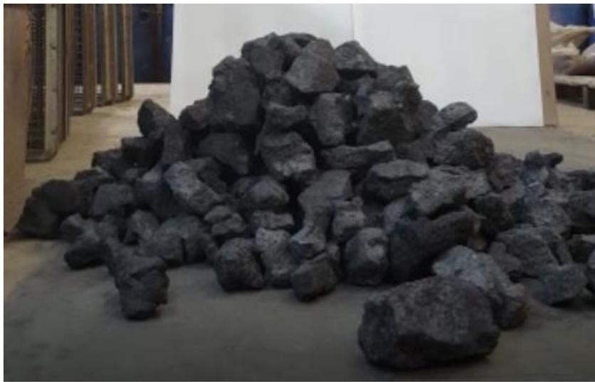
Figura 5.3 - Teste de ângulo de repouso com coque grosso
