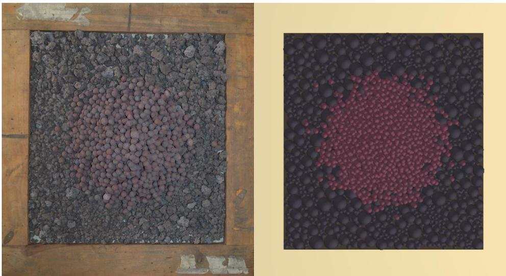
Figura 5.13 - Vista superior da pilha de pelotas formada sobre leito de partículas de sinter
