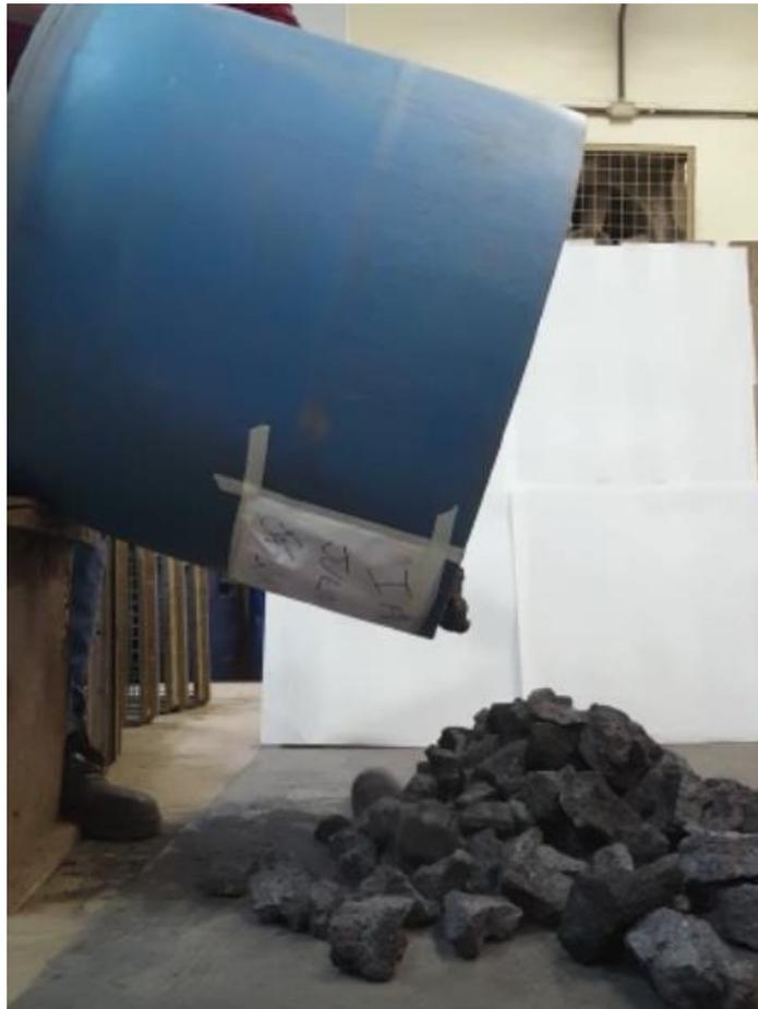
Figura 4.2 - Execução do ensaio de determinação do ângulo de repouso para a amostra de coque grosso
