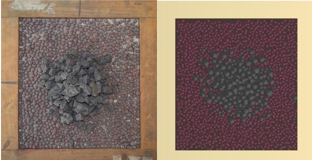
Figura 5.11 - Vista superior da pilha de coque formada sobre leito de partículas de pelotas
