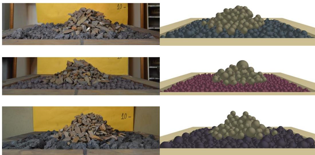
Figura 5.15 - Pilha de minério de ferro sobre leito de partículas de sinter, pelotas e coque de cima para baixo respectivamente. Experimento (à esquerda) e simulação DEM (à direita).
