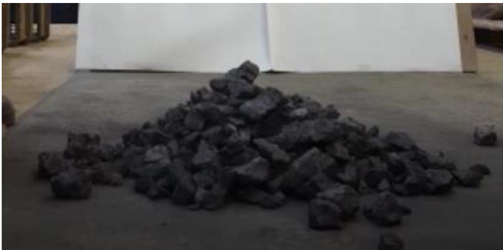
Figura 5.5 - Teste de ângulo de repouso com *small* coque
