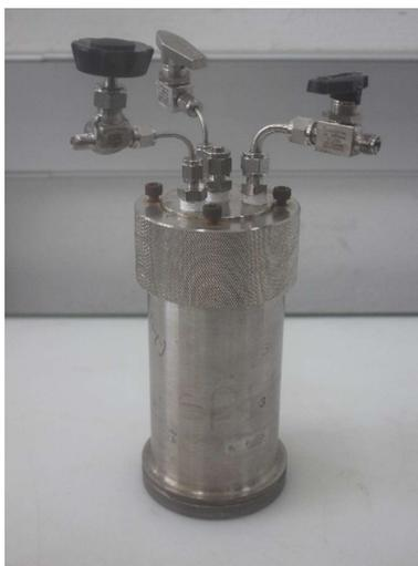
*Figura 13: Uma das autoclaves utilizadas no processo de envelhecimento*
