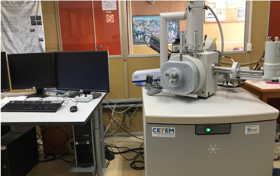
Figura 4.15- Microscópio eletrônico de varredura FEI Quanta 400 instalado no CETEM
