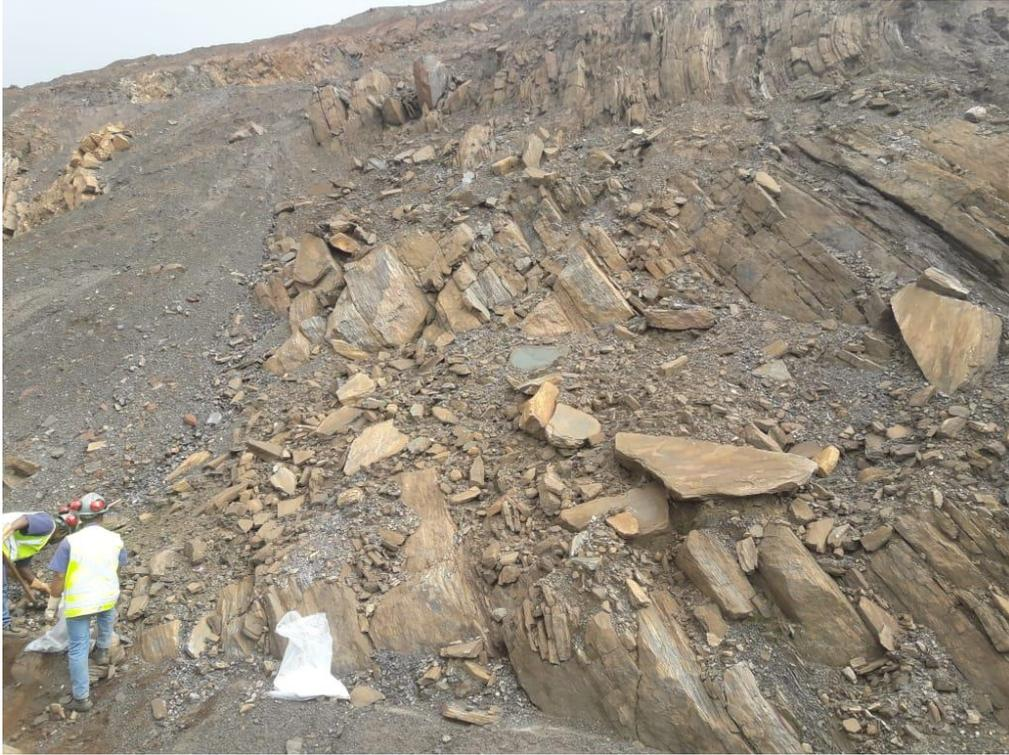
Figura 4.6 – Retirada da amostra de ICS da frente de lavra 14G. Coordenadas: 612260 E 7737552 N
