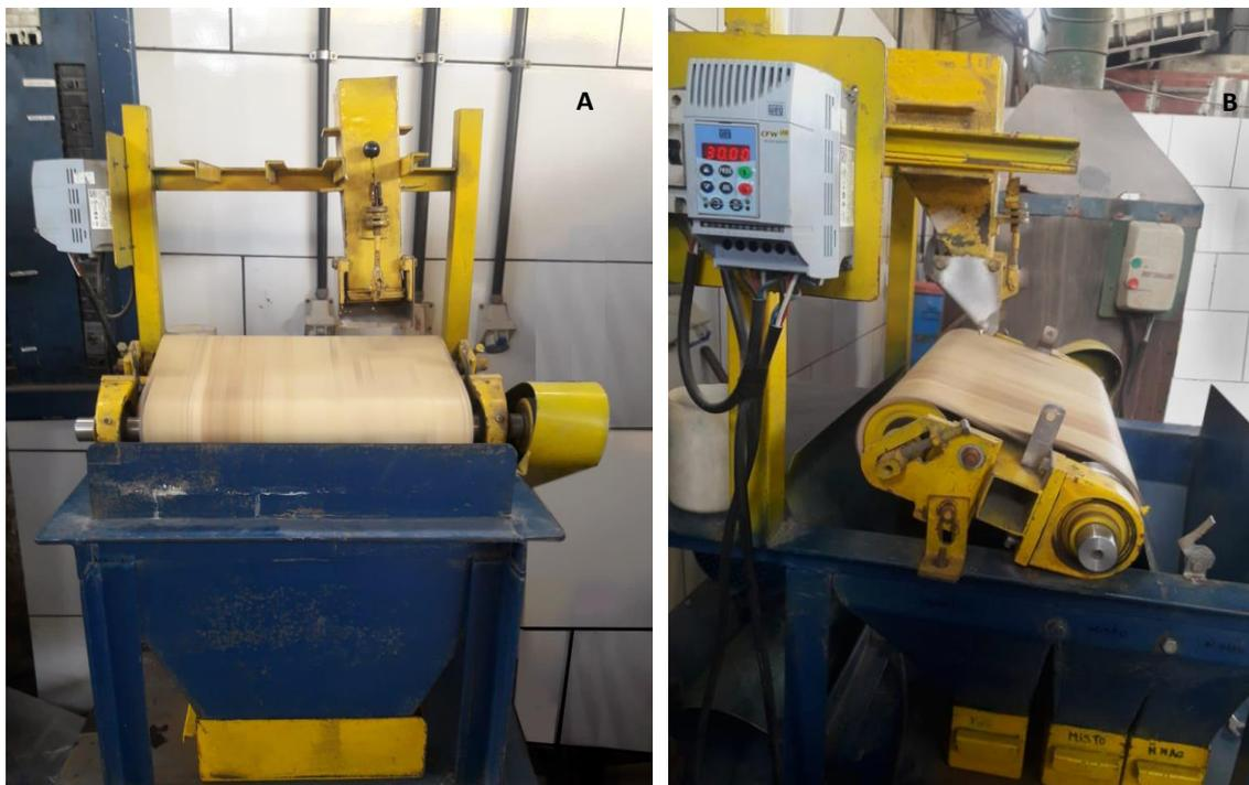
Figura 4.21 – Separador de rolos de ímas permanentes de baixa e alta intensidade. Vista Frontal (A); vista Lateral (B)
