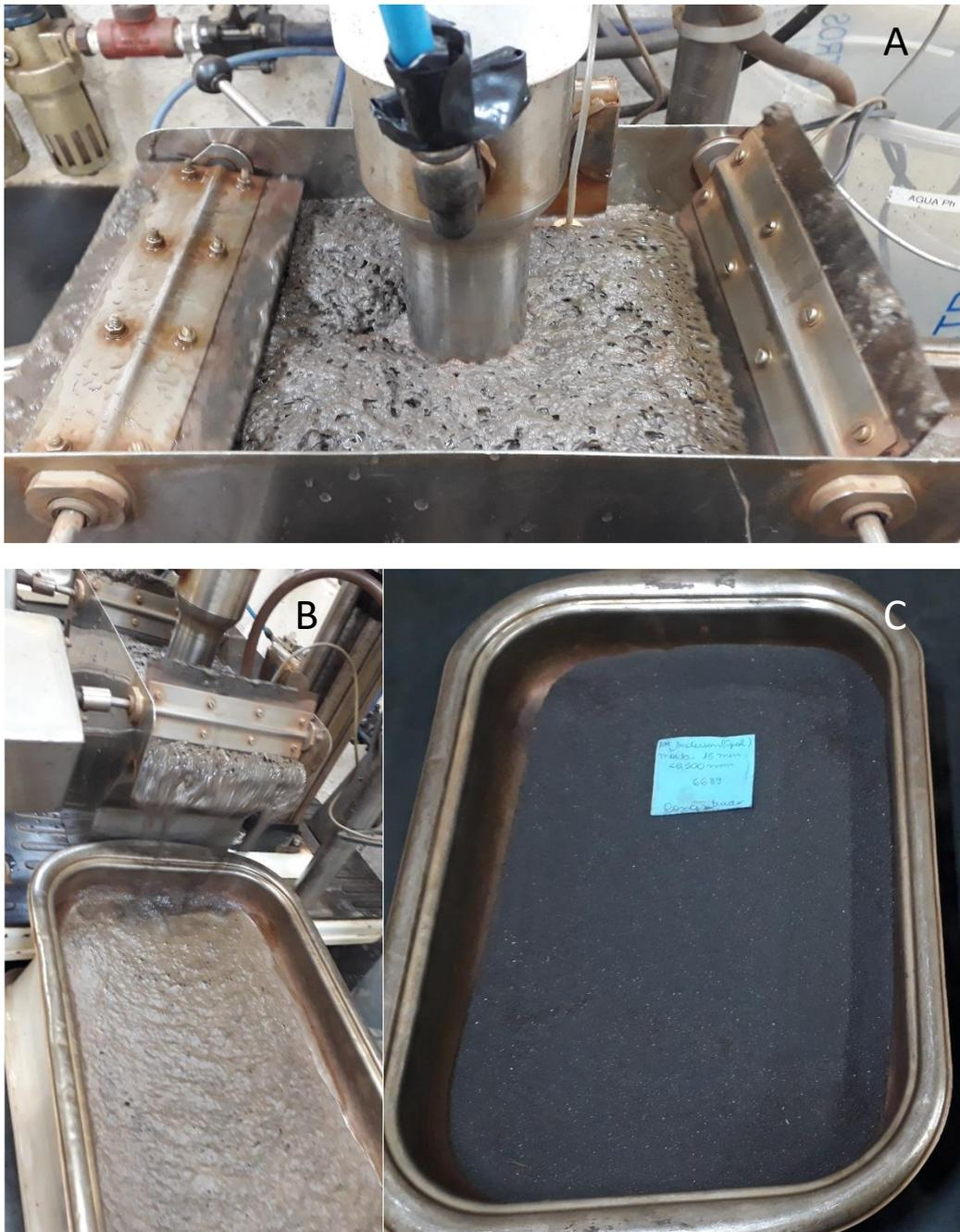
Figura 4.19- Célula de bancada CDC, utilizada nos testes de flotação (A). Coleta de SiO<sub>2</sub> flotado (B). Concentrado deprimido após a secagem (C)
