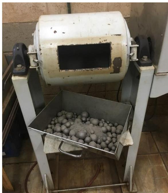
Figura 4.18- Moinho de bolas utilizado no teste de Wi.
