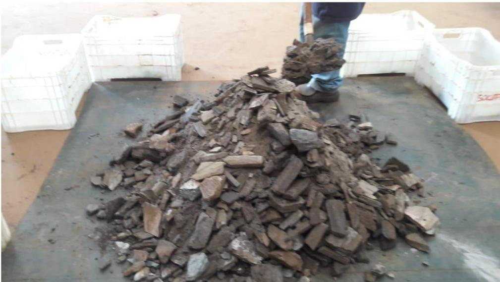
Figura 4.7 – Homogeneização das alíquotas no galpão de Geologia da Mina de Casa de Pedra
