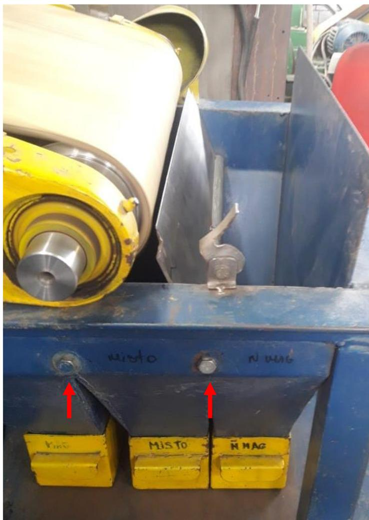
Figura 4.22 – Detalhe do *flap* de corte do separador magnético a seco. O ajuste na distância é feito rotacionando os parafusos em destaque.
