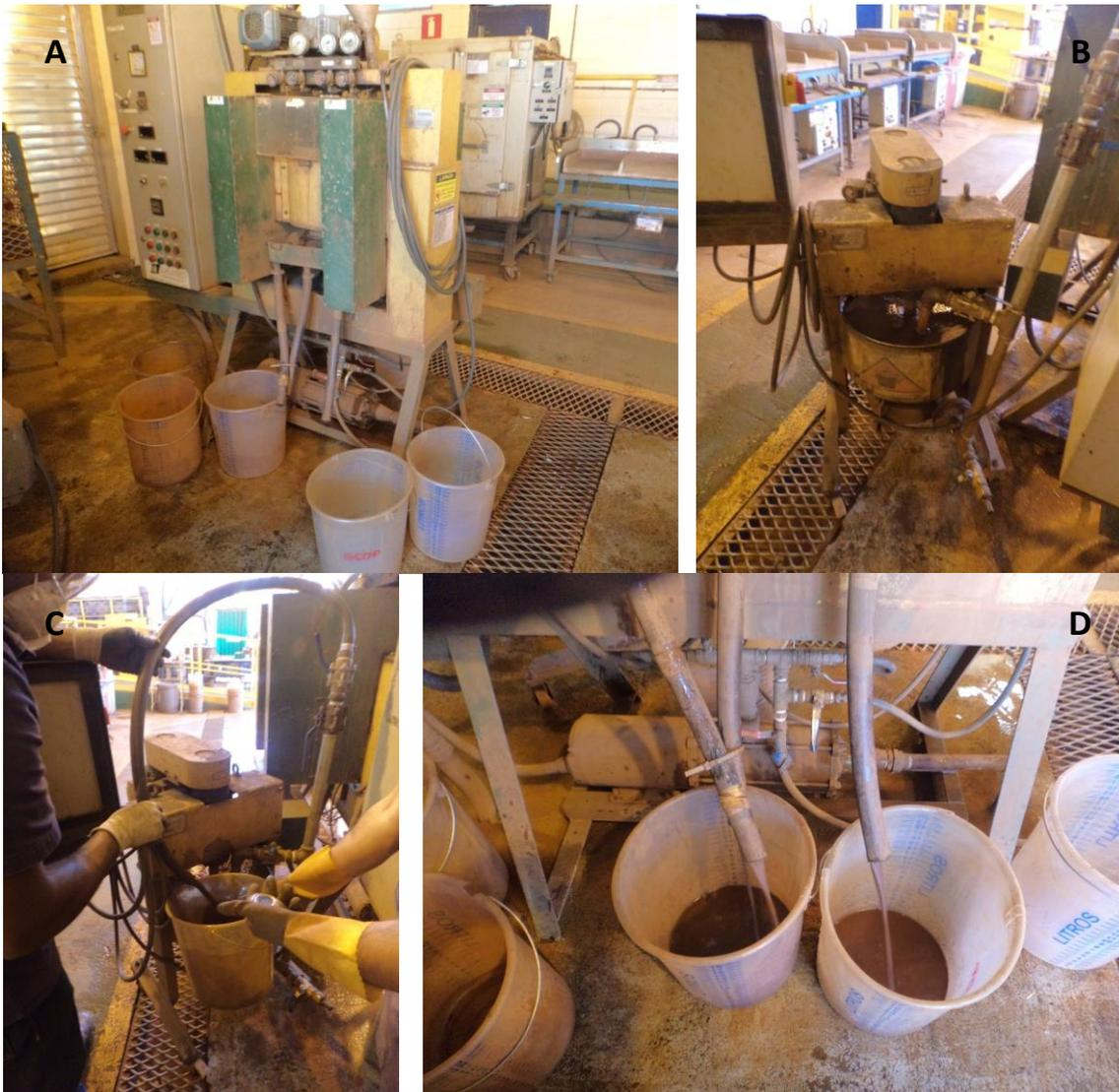
Figura 4.20- Equipamento CMAI modelo Gaustec, instalado no laboratório de processos da CSN Mineração (A).
