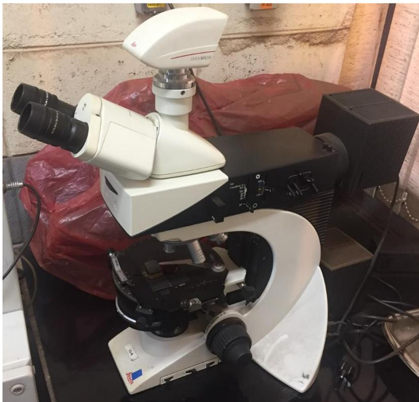
Figura 4.17 – Microscópio Ótico LeicaDM250P com câmera acoplada.
