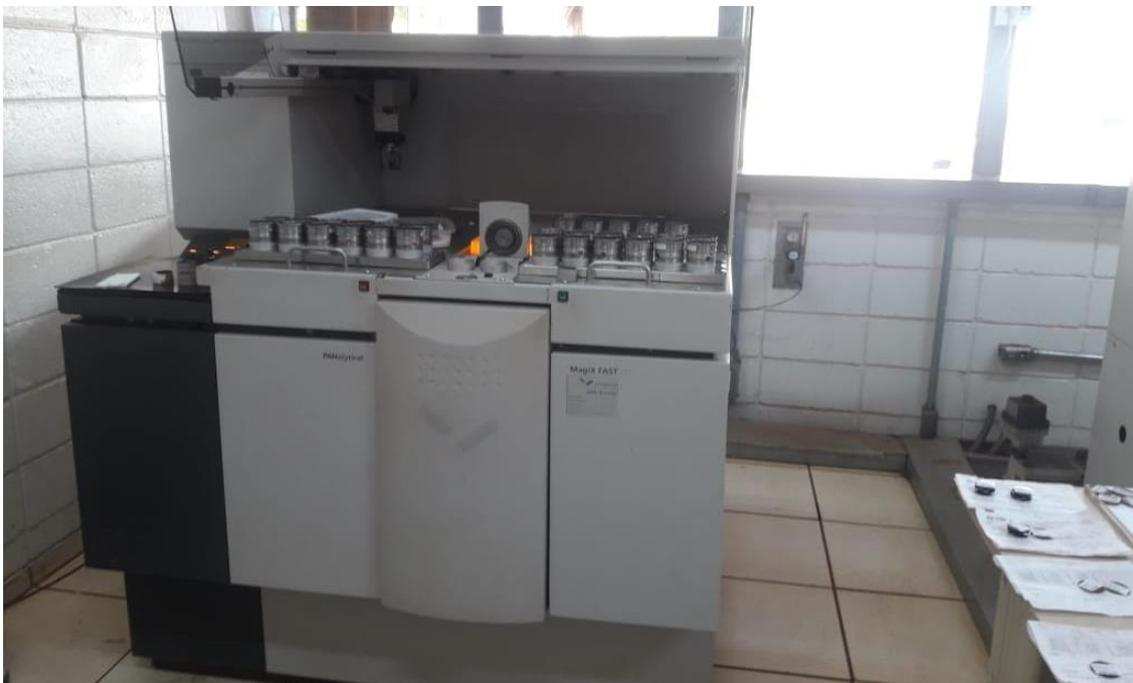
Figura 4.10 – Equipamento de Fluorescência de raio-X, localizado no laboratório químico da Mina de Casa de Pedra
