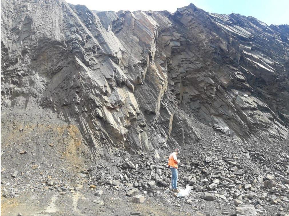
Figura 4.4 – Retirada da amostra de ICS da frente de lavra 11F. Coordenadas: 611557 E 7736689 N
