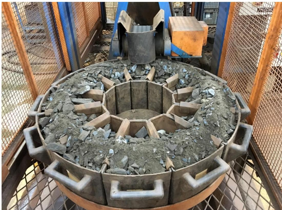
Figura 4.8 – Quarteador rotativo utilizado para homogeneização e quarteamento das alíquotas
