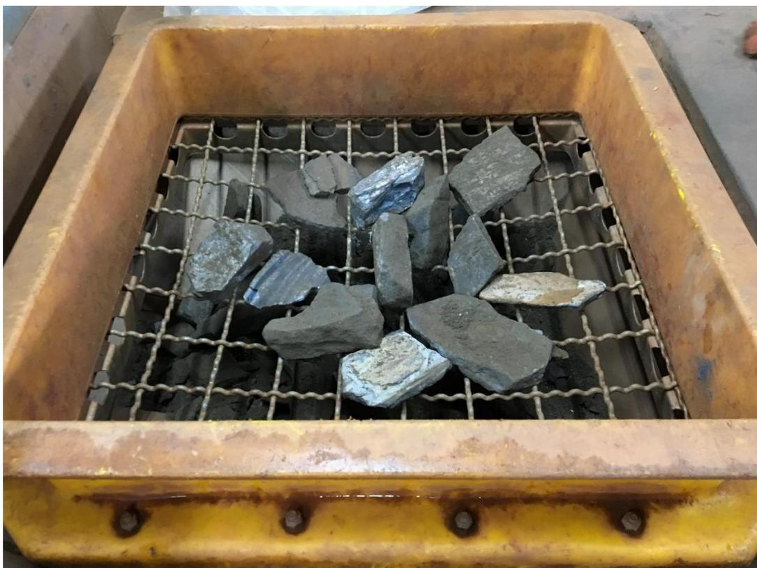
Figura 4.9 – Fração retida na peneira de 50 mm
