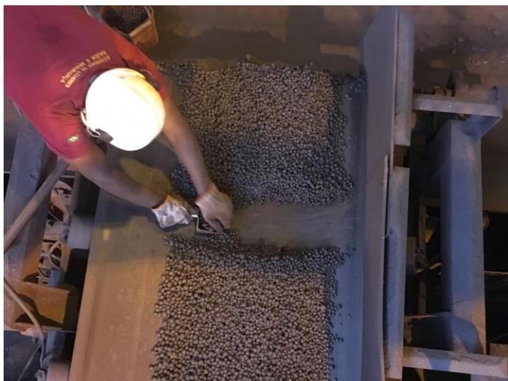
Figura 72 - Ponto de coleta sobre a correia 5P27 onde foram retiradas 18,5 kg de pelotas verdes
