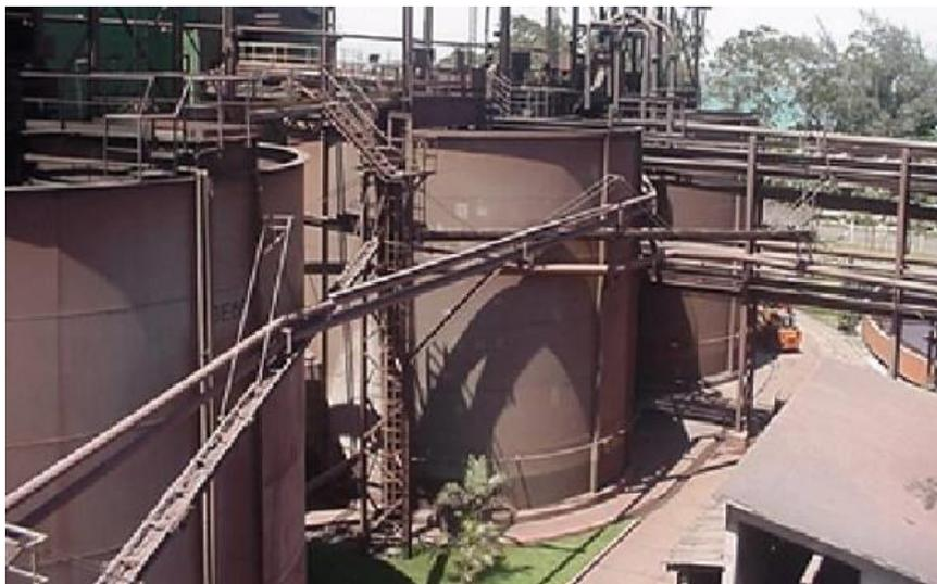
Figura 10 - Tanques homogeneizadores na usina de pelotização da Vale S.A.
