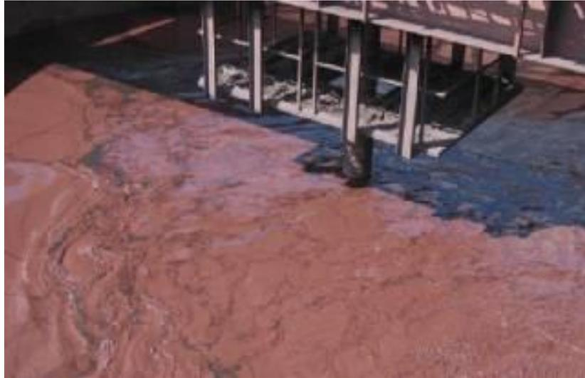
Figura 9 - Polpa de minério de ferro homogeneizada com carvão mineral
