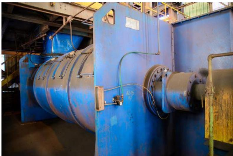
Figura 13 - Misturador cilíndrico rotativo na usina de pelotização da Vale S.A.
