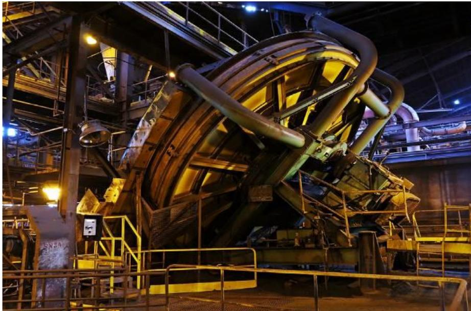
Figura 15 - Disco de pelotamento na usina de pelotização da Vale S.A.
