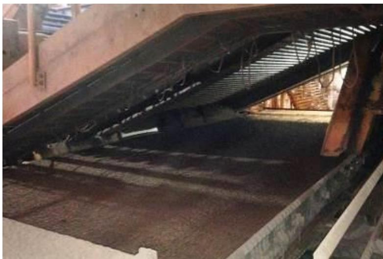
Figura 44 - Vista inferior da peneira de rolos duplo *deck*, mostrando a retirada de finos de pelotas verdes
