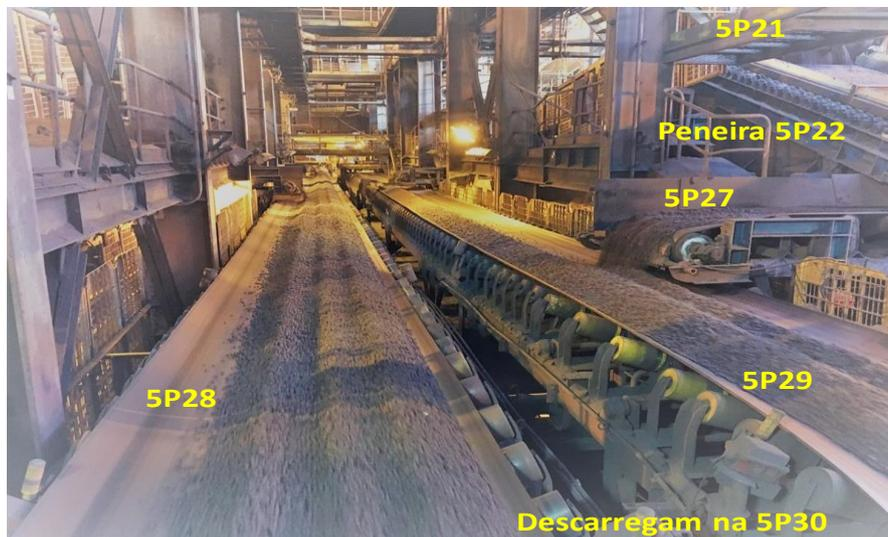
Figura 81 - Rota de manuseio e transporte das pelotas verdes ao saírem dos discos de pelotamento
