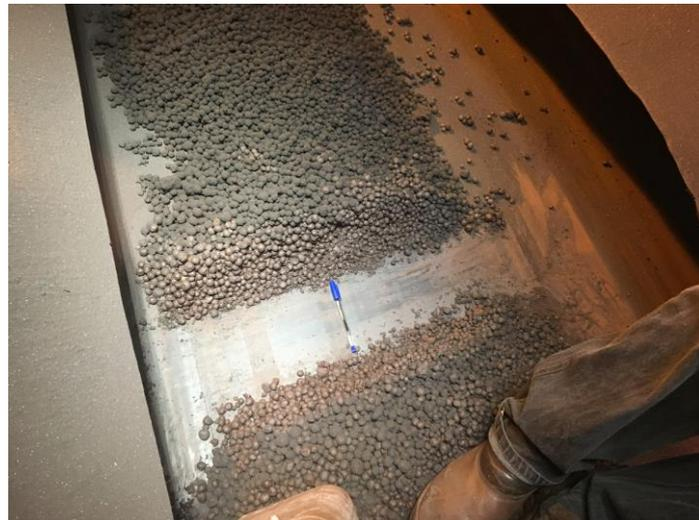
Figura 71 - Ponto de coleta sobre a correia 5P21B, de onde foi retirada amostra contendo 26 kg de pelotas verdes
