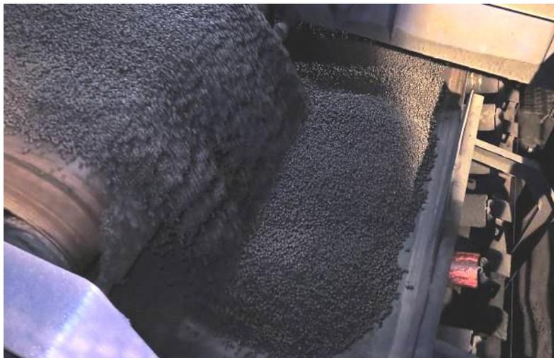
Figura 41 - Vista superior do chute móvel
