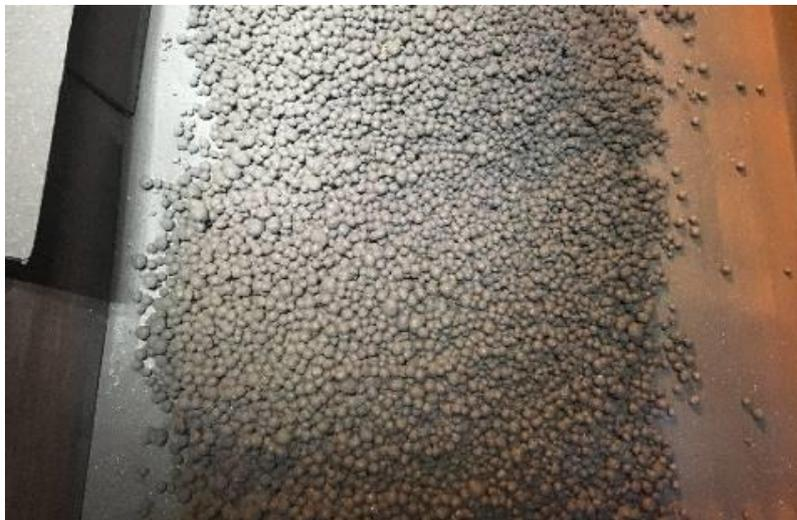
Figura 24 - Fluxo de pelotas verdes em correia transportadora que recebe a descarga do disco de pelotamento
