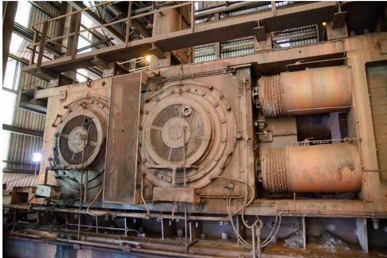
Figura 12 - Prensa de rolos na usina de pelotização da Vale S.A.
