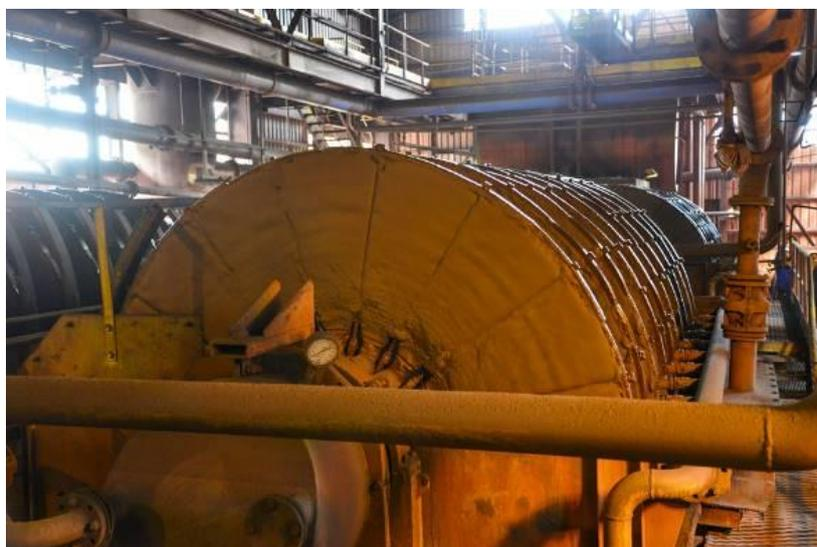
Figura 11 - Filtro de disco a vácuo na usina de pelotização da Vale S.A.
