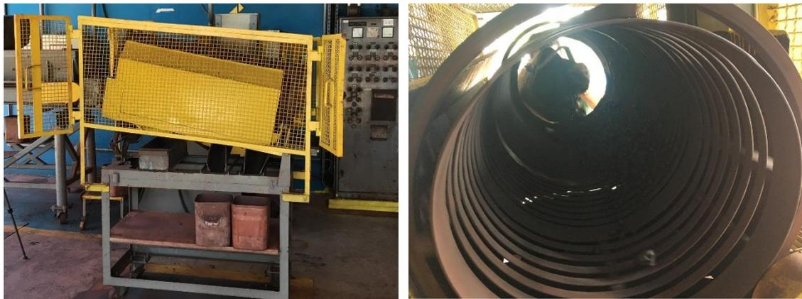
Figura 68 – Peneira circular rotativa. Vista lateral (esquerda) e frontal (direita)
