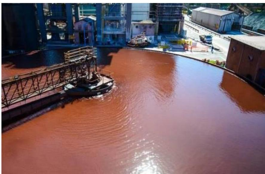
Figura 8 – Espessador de polpa de minério de ferro
