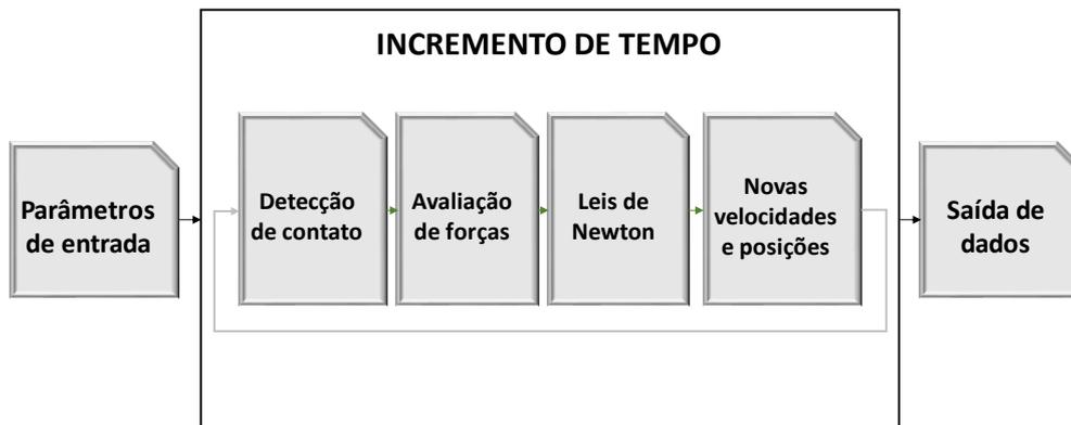
Figura 60 - Fluxo básico de funcionamento do DEM (CUNDALL e STRACK, 1979)
