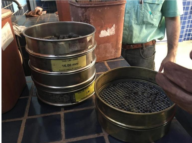
Figura 74 - Peneiramento manual em peneiras com aberturas quadradas
