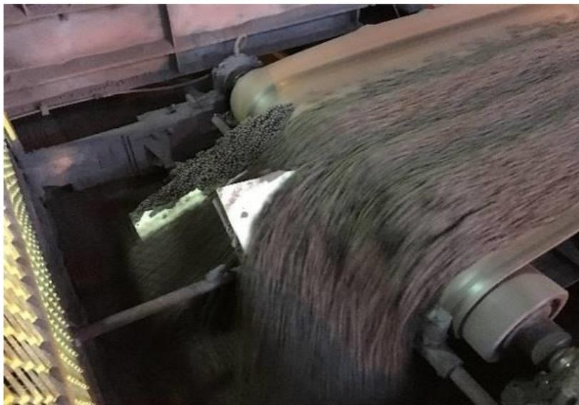
Figura 39 - Transferência de pelotas verdes com o auxílio de defletores de PEAD
