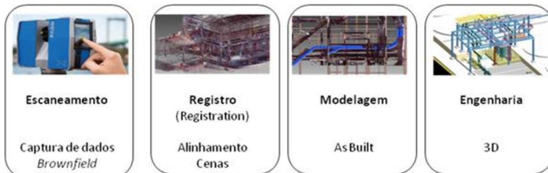
Figura 78 - Esquema ilustrativo das operações envolvidas no escaneamento 3D
