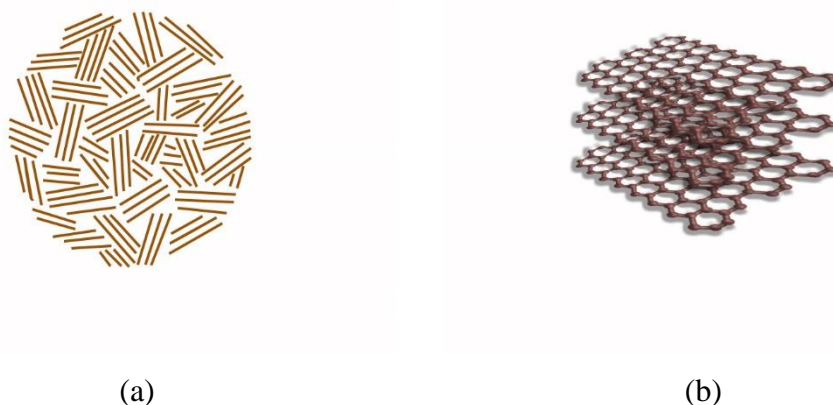
Figura 3.24 - (a) Orientação aleatória dos cristais de negro de fumo; (b) cristalito típico de NF (adaptado de HU, 2010).
