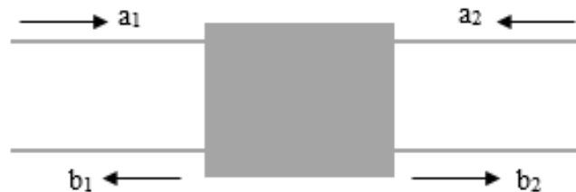
Figura 3.16 - Esquema de propagação do sinal em duas portas (adpatato de COLLIER; SKINNER, 2007).
