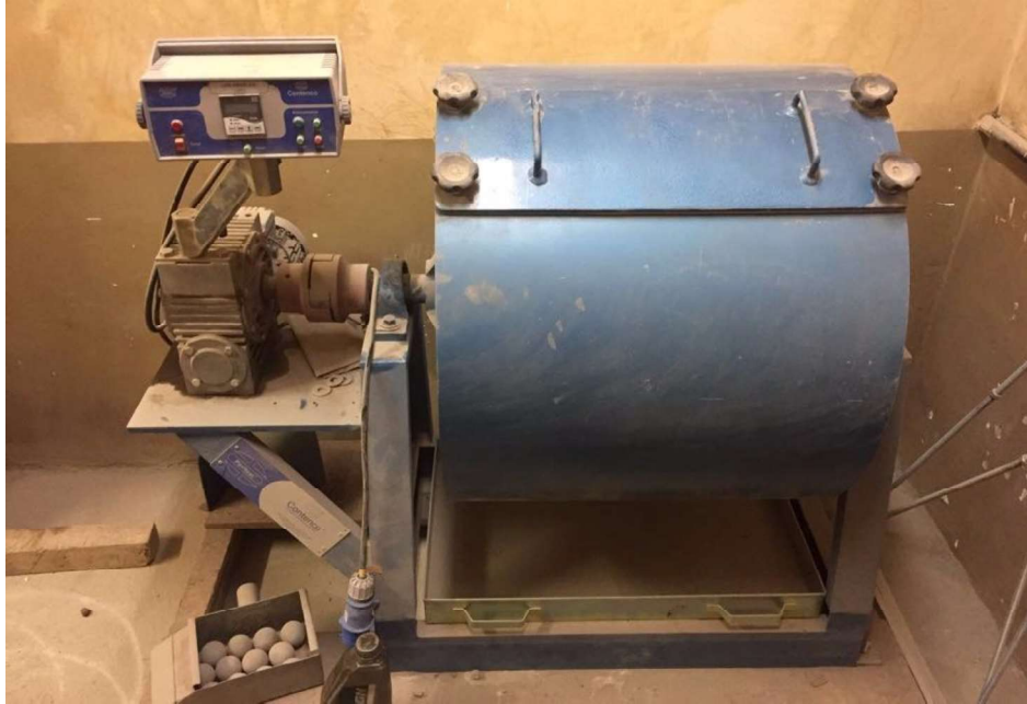
Figura 4.3 - Moinho padronizado para o ensaio de Abrasão Los Angeles
