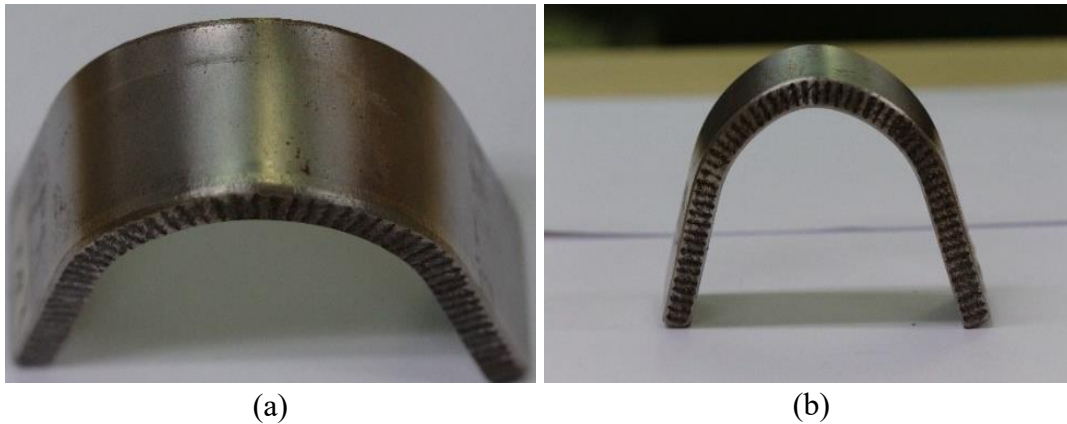
Figura 49: Macrografias de umas das amostras do ensaio de dobramento.
