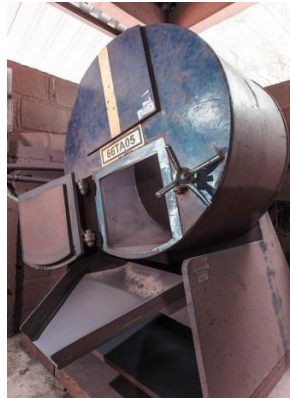
Figura III. 25 – Tambor de abrasão onde é avaliado o Índice de Tamboramento das pelotas queimadas de acordo com a norma ISO 3271.
