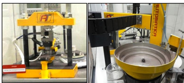
Figura III. 24 – Equipamento de testes de Resistência à Compressão das pelotas.
