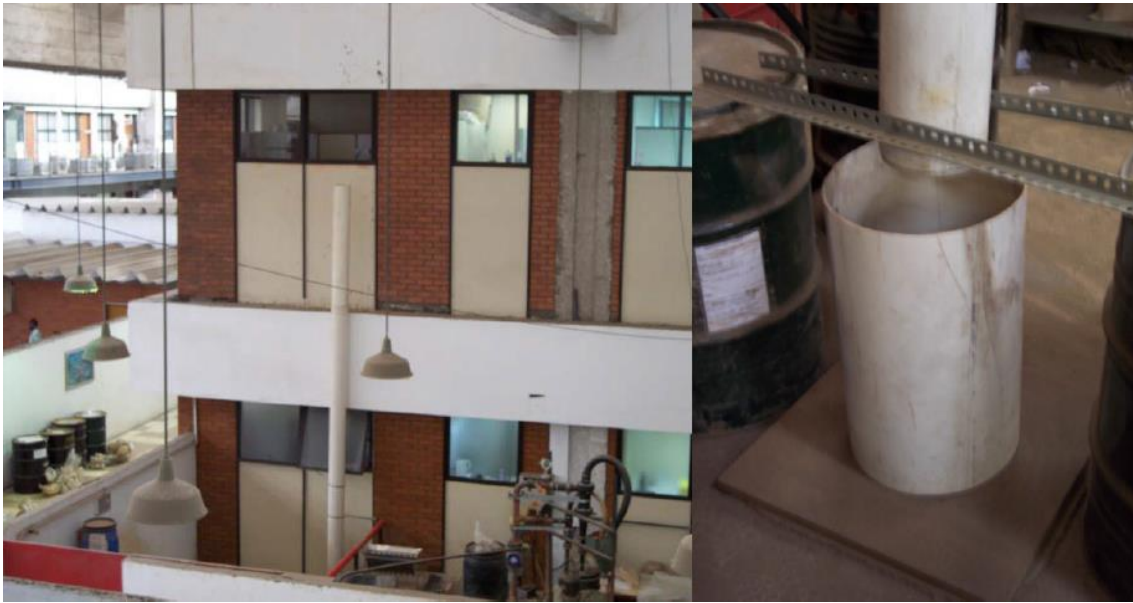
Figura V. 7 – Sistema construído em laboratório para os ensaios de autofratura.
