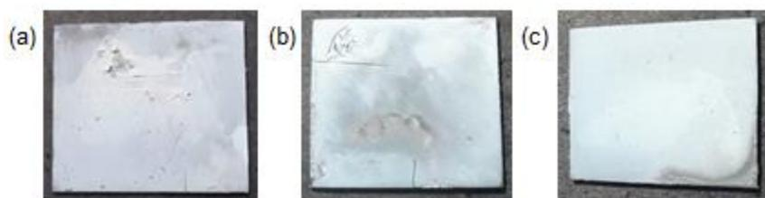
Figura 27 - Fotografia das placas de nióbio submetidas a rota hidrotérmica alcalina a 80°C, 24 h, com NaOH 0,5M.
