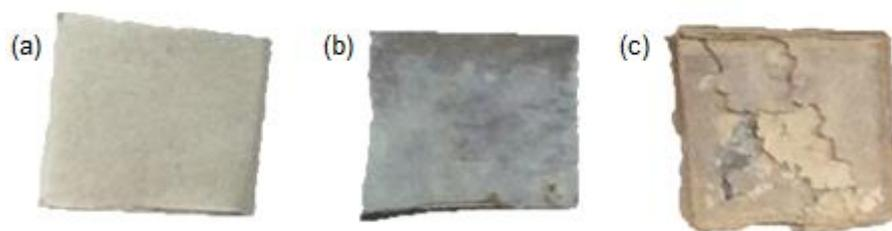
Figura 22 – Fotografias da placa de nióbio após lixamento (a), após síntese hidrotérmica (B), e após tratamento térmico (c).
