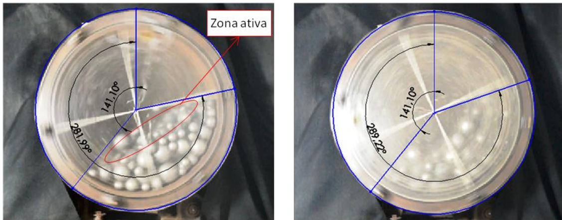
Figura 5.7. Carga no interior do moinho 305 x 305 mm. Somente corpos moedores (Esquerda) - corpos moedores e minério (Direita)
