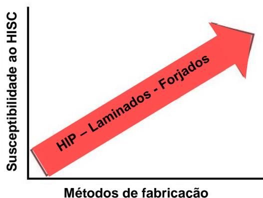
Figura 35 - Susceptibilidade à corrosão em função da técnica de fabricação [2].
