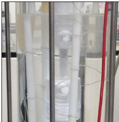
Figura 101 – Grande geração de bolhas de H<sub>2</sub> em ambiente de alta fugacidade durante ensaio de tração em baixa taxa de deformação.
