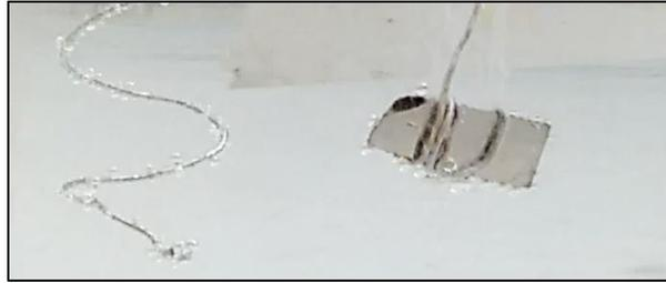
Figura 60 – Amostra hidrogenada eletroliticamente para ensaio TDS. Observe a geração de bolhas na superfície metálica.
