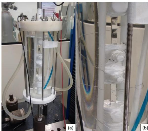
Figura 54 – Célula para hidrogenação eletrolítica sob tensão elástica. Na figura à esquerda (a), esquema da célula, enquanto que na direita (b), um maior detalhamento dos corpos de prova. Observe que apenas o comprimento útil foi exposto à hidrogenação.
