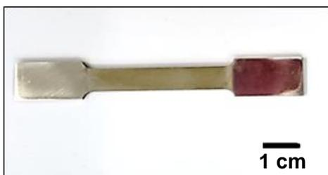
Figura 52 - Corpo de prova para ensaio de tração.
