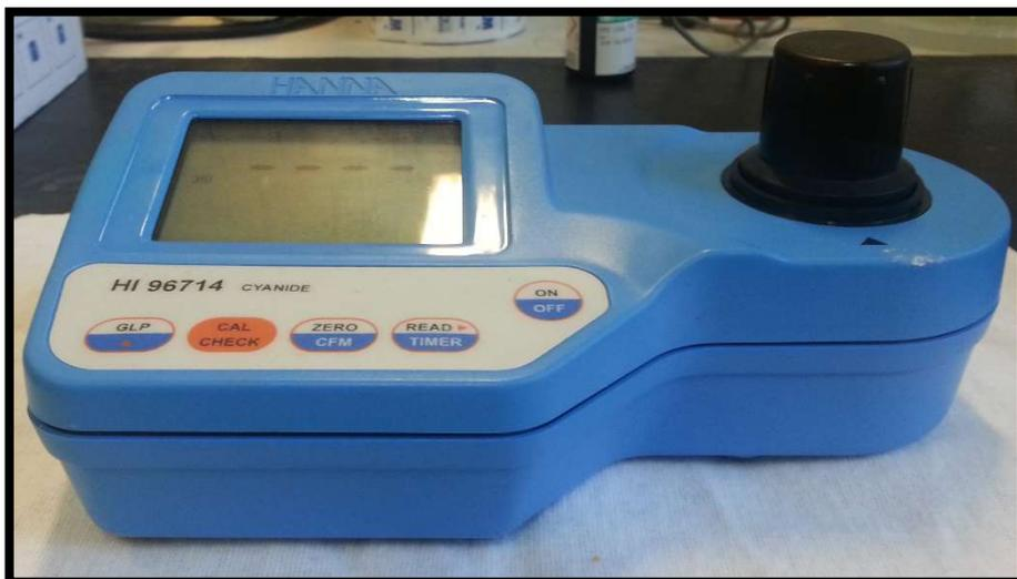
Figura 6 - Fotômetro para análise de cianeto total pelo método piridina-piralozona.
