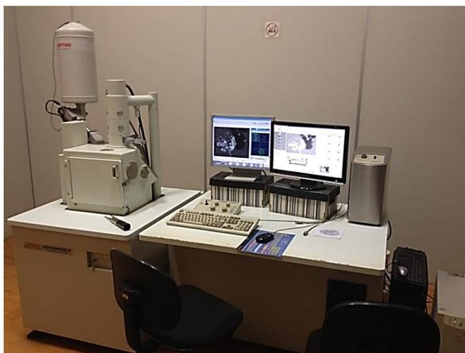
Figura 61: MEV JEOL® modelo JSM-6460LV.
