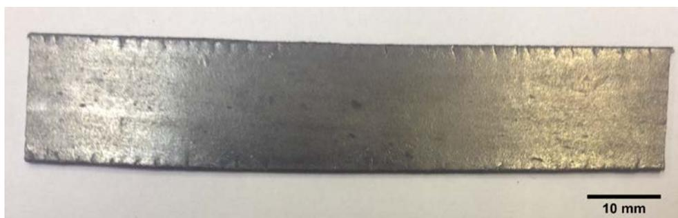
Figura 40 – Peça da chapa da liga ZB-2 após tratamento térmico.
