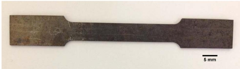
Figura 36 – Corpo de prova tração da liga Zr-1Nb após tratamento térmico.
