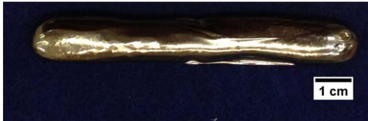
Figura 31 – Primeiro lingote da liga Zr-1Nb obtido após fusão.
