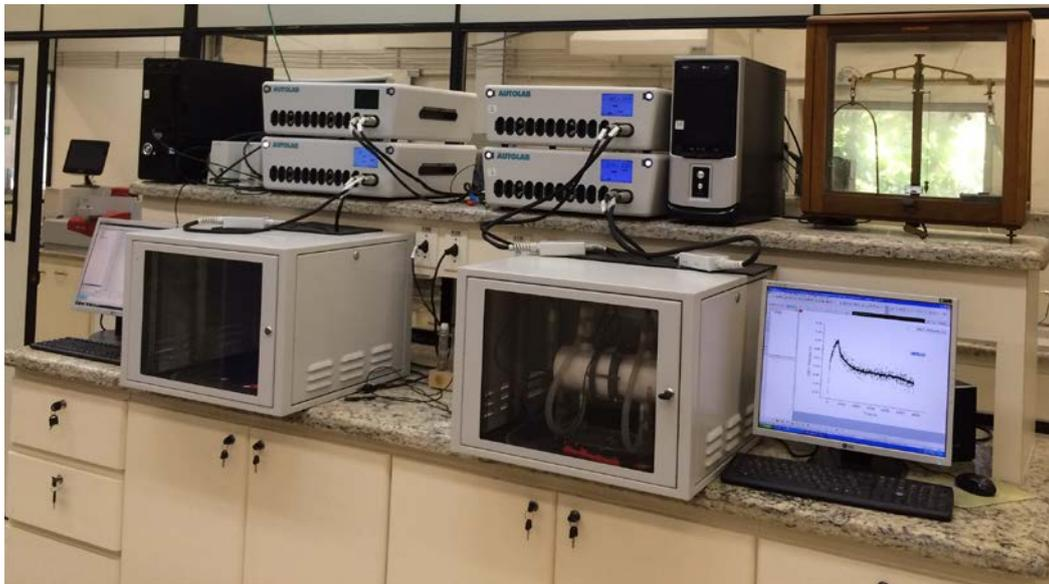
Figura 37 – Potenciosatatos utilizados para o ensaio de polarização.
