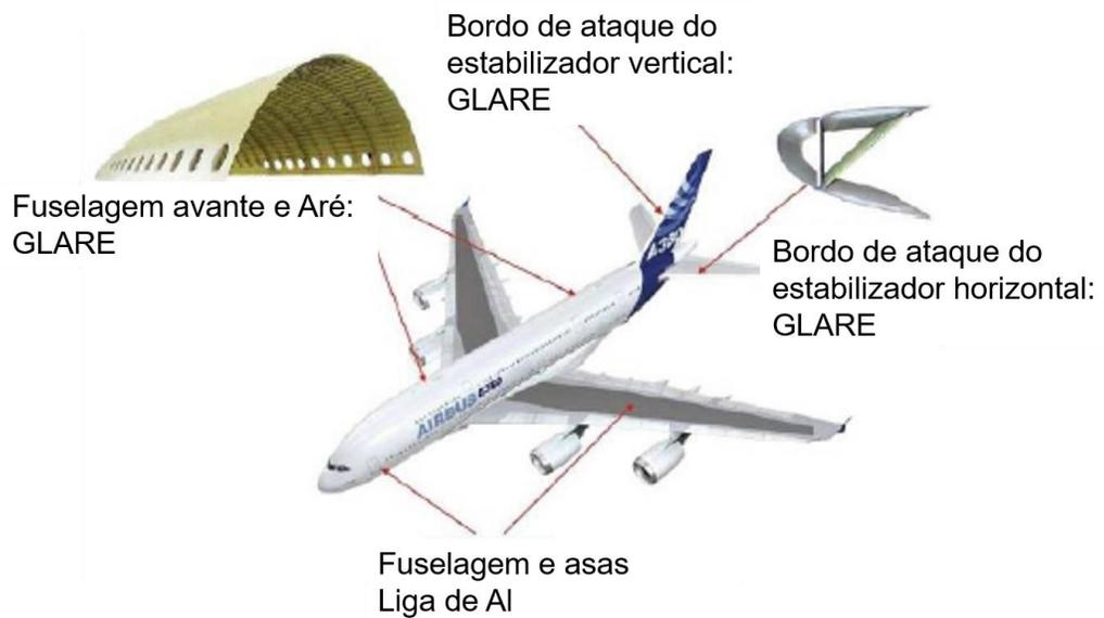
Figura 10– Figura esquemática do Airbus A380 mostrando as partes onde o laminado GLARE foi utilizado.
