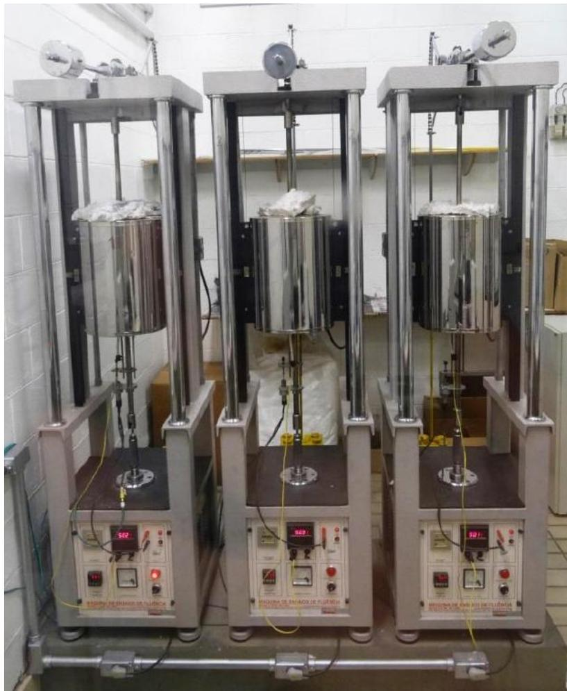
**Figura 3.3.** Máquinas de ensaio de fluência modelo STM/MF 1000.
