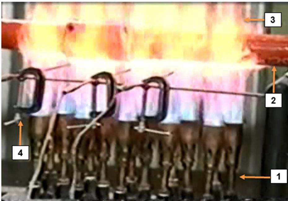
Figura 21: Realização do ensaio de aplicação de chama impingente.
