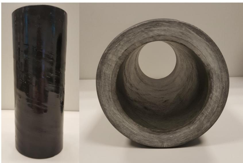
**Figura 5: Compósito com revestimento contra incêndio.**
