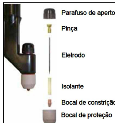
Figura 2.61: Componentes básicos de uma tocha para soldagem plasma (Adaptado de Arcdynamics, 2014).
