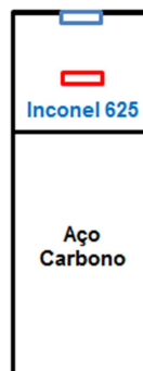
Figura 3.23: Região (retângulos azul e vermelho) submetida ao EDS para semiquantificação do teor de Fe.
