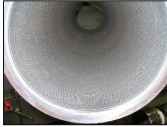
Figura 3.10: Superfície do diâmetro interno de um tubo revestida com o processo de soldagem plasma pó de arco transferido feito com a tocha modelo HPI 350. (Adaptado de Comersul).
