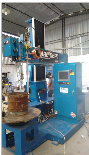
Figura 2.48: Equipamento Arc 05 PL, do fabricante Arc Specialties, utilizado para cladar, ou seja, revestir peças cilíndricas através do processo TIG arame quente (Adaptado de Arcdynamics Equipamentos de Corte Plasma e Solda, 2016).
