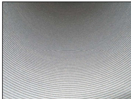
Figura 3.11: Superfície interna de um tubo de aço carbono revestida com pó metálico pelo processo de soldagem plasma pó. (Adaptado de Comersul).
