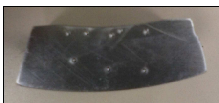
Figura 4.23: Indentações esféricas feitas no metal de base e na metade da espessura do revestimento (CENPES TMEC).
