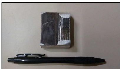
Figura 4.22: Indentações esféricas feitas na superfície do revestimento de Inconel 625, PTA (CENPES TMEC).
