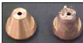
Figura 2.66: Bocal (bico) de constrição à esquerda e após a formação de arco-duplo, à direita (Adaptado de REIS, R.; SCOTTI, A, 2007).
