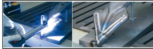
Figura 2.141: Aplicação de consumível antiabrasivo pelo processo PTA sobre ferramenta manual (Adaptado de TBi).
