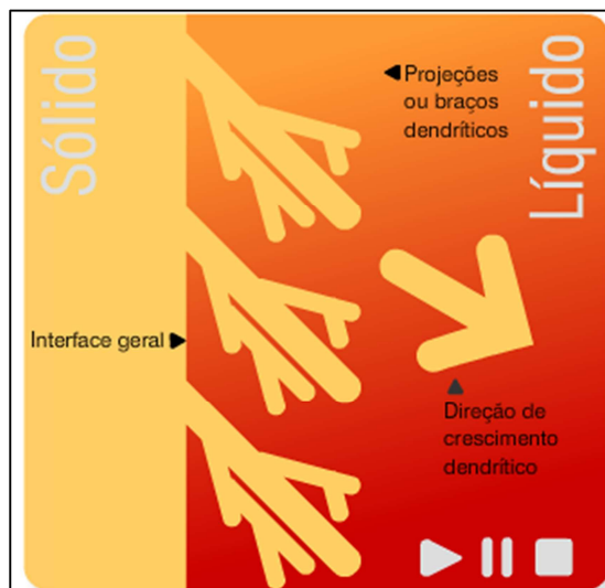
Figura 2.127: Formação de dendritas durante a solidificação da poça de fusão (Adaptado de Ciências dos Materiais, 2016).
