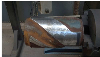
Figura 2.139: Estabilizador utilizado na indústria de petróleo, necessitando de reparo em lâminas (Adaptado de Kennametal,).
