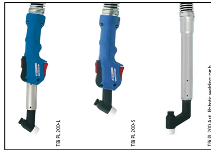
Figura 2.103: Tocha de soldagem plasma pó com adição interna de pó consumível (Adaptado de TBi).
