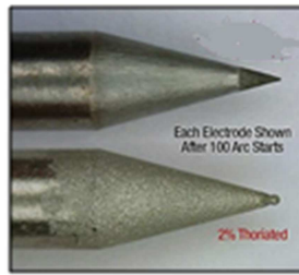
Figura 2.39: Efeito no ângulo da ponta dos eletrodos de tungstênio E3 e o eletrodo de tungstênio com 2% de tório, depois de 100 aberturas de arco (Adaptado de E3 Tungsten, 2015).
