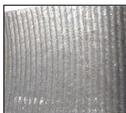
Figura 4.1: Peça revestida com PTA, usando Nistelle 625 (Inconel625) (CENPES TMEC).
