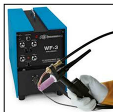
Figura 2.8: Alimentador de arame utilizado no processo TIG semi-automático (Adaptado de CK Worldwide).
