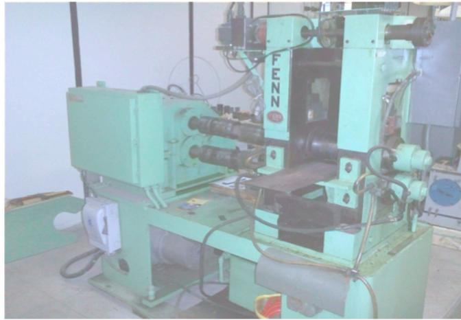
Figura 3.4: Imagem do laminador modo duo/quádruplo reversível de marca FENN da COPPE/UFRJ, utilizado no presente trabalho.
