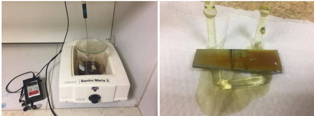
**Figura 34 Ensaio de CPT de acordo com a norma G-48: (a) aparato de teste; (b) berço que suporta as amostras.**
