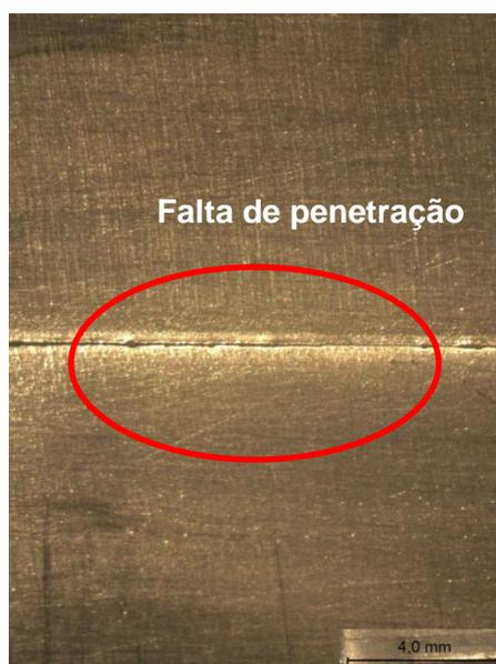
**Figura 39 Imagem da raiz da Solda – Ar + 2,5% N<sub>2</sub> 0,202 kJ/mm**
