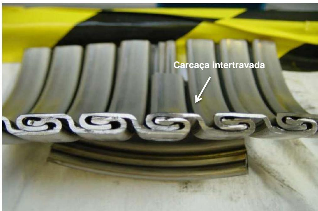
**Figura 3 – Perfil da carcaça intertravada. Adaptado de (Simões, 2011).**
