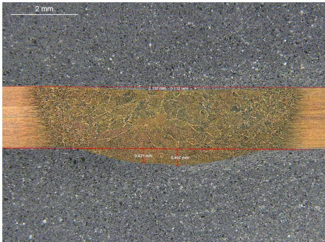
**Figura 32 - Medição da penetração e falta de deposição em uma junta soldada de maior espessura.**
