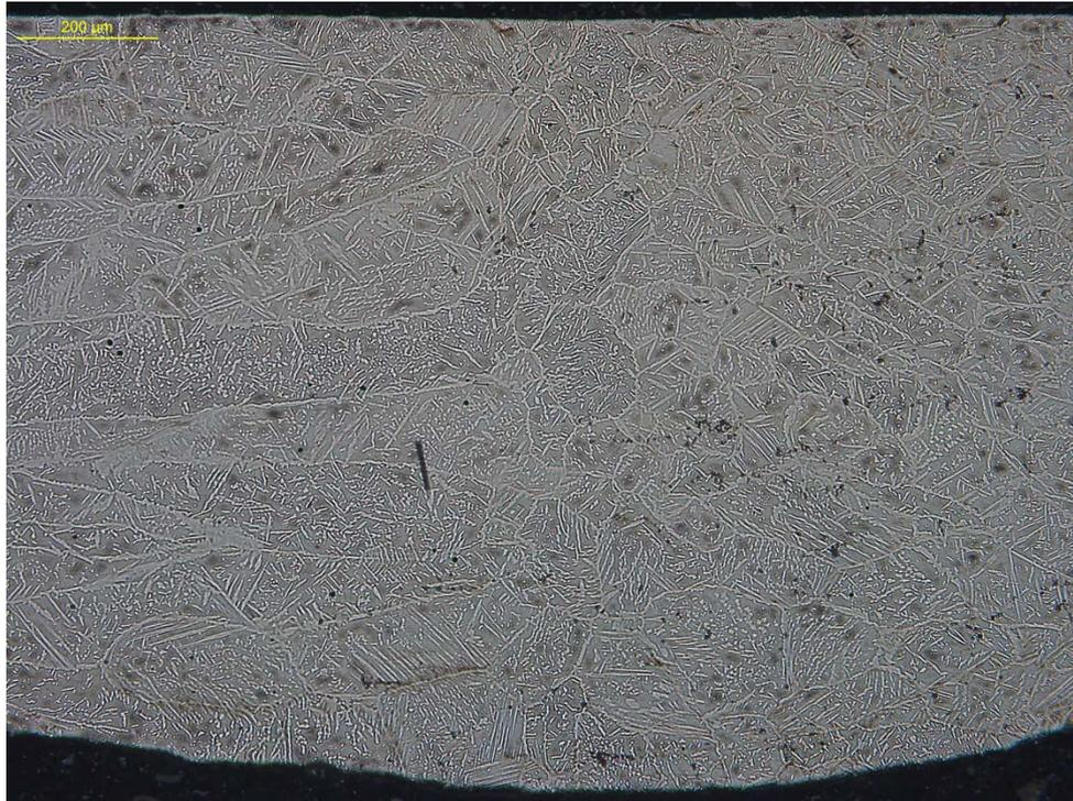
**Figura 46 Imagen do centro do cordão de solda com aumento de 50x – Ar + 2,5% N<sub>2</sub>**
