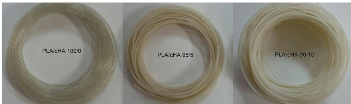
**Figura 5.1.** Filamentos de PLA/cHA 100/0, 95/5 e 90/10 obtidos por extrusão.
