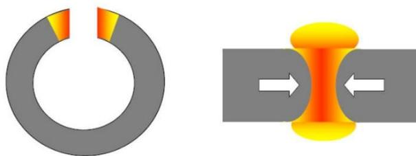
**Figura 2.31.** Ilustração de uma tubulação sendo soldada por indução [63].
