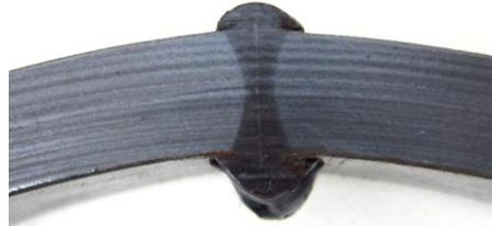
**Figura 2.28.** Aspecto macrográfico de um tubo soldado por indução sem usinagem pós-soldagem.
