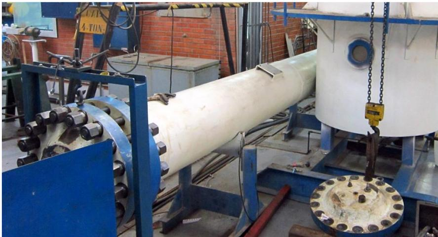
**Figura 3.6.** Aspecto externo da câmara utilizada para o ensaio de colapso.
